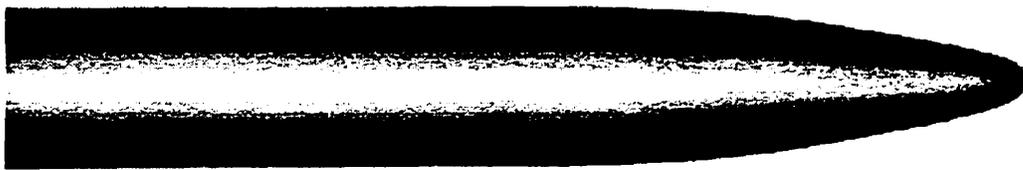
**Figure A.3:** Photographie d'une fibre optique effilée à bout hémisphérique que nous avons fabriquée.  $L = 300 \mu\text{m}$ ,  $r = 14.4 \mu\text{m}$ .
