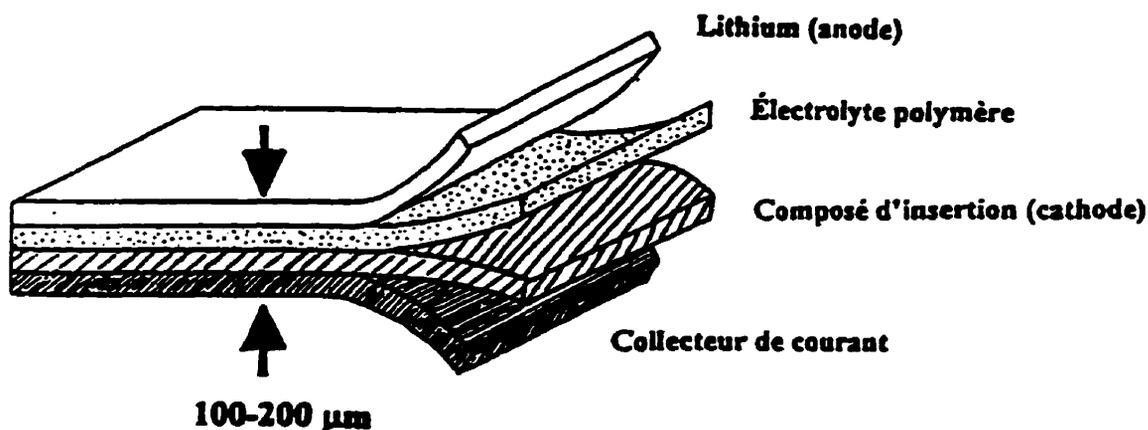
Figure I.1: Éléments d'un accumulateur au lithium impliquant un électrolyte polymère.
