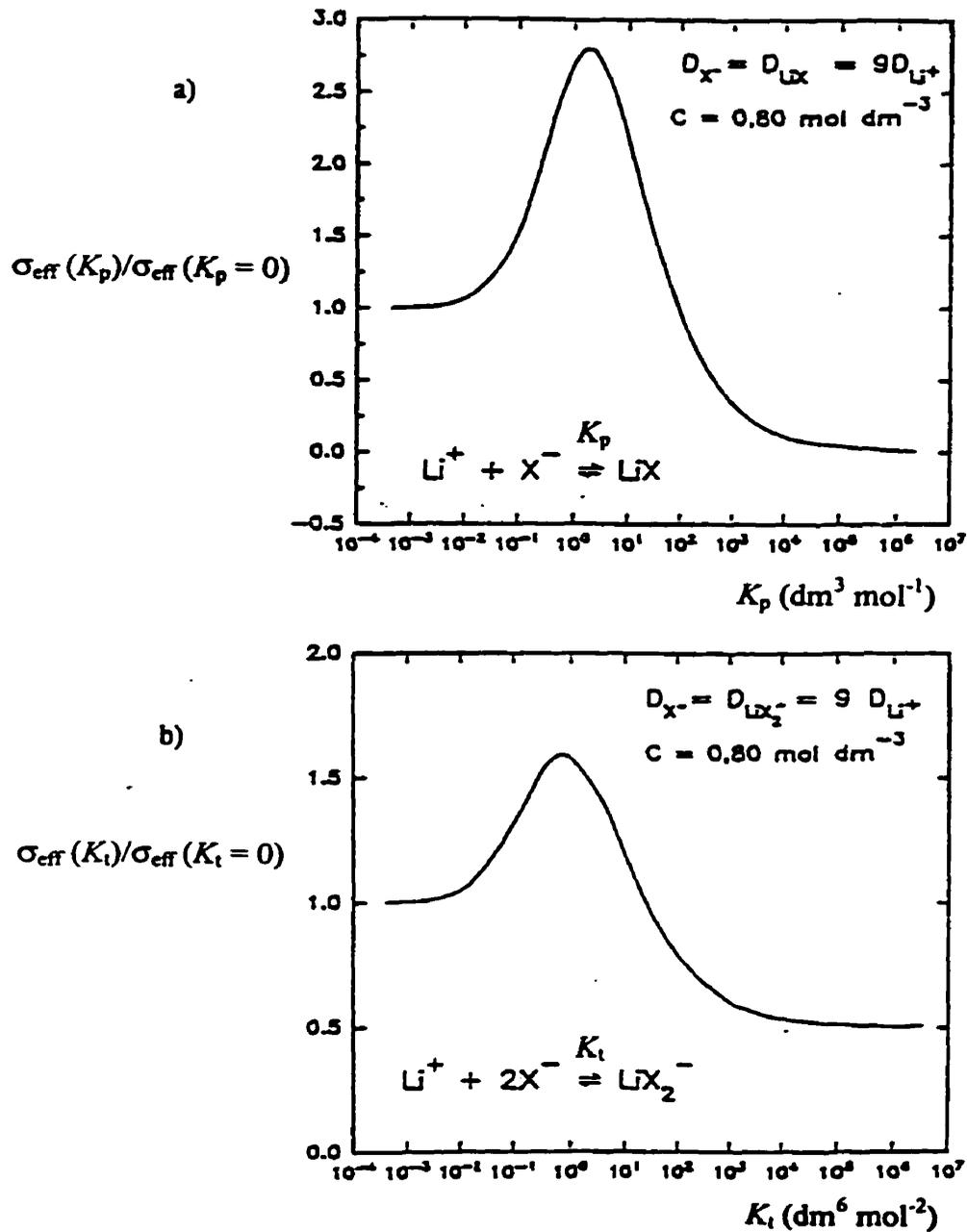
**Figure I.2:** Effet de la constante d'association sur la conductivité cationique effective d'un système POE-LiX contenant (a) des paires d'ions et (b) un complexe anionique (triplet)  $LiX_2^-$ . Courbes théoriques calculées par Lascaud<sup>(28)</sup> dans l'hypothèse d'un électrolyte idéal.
