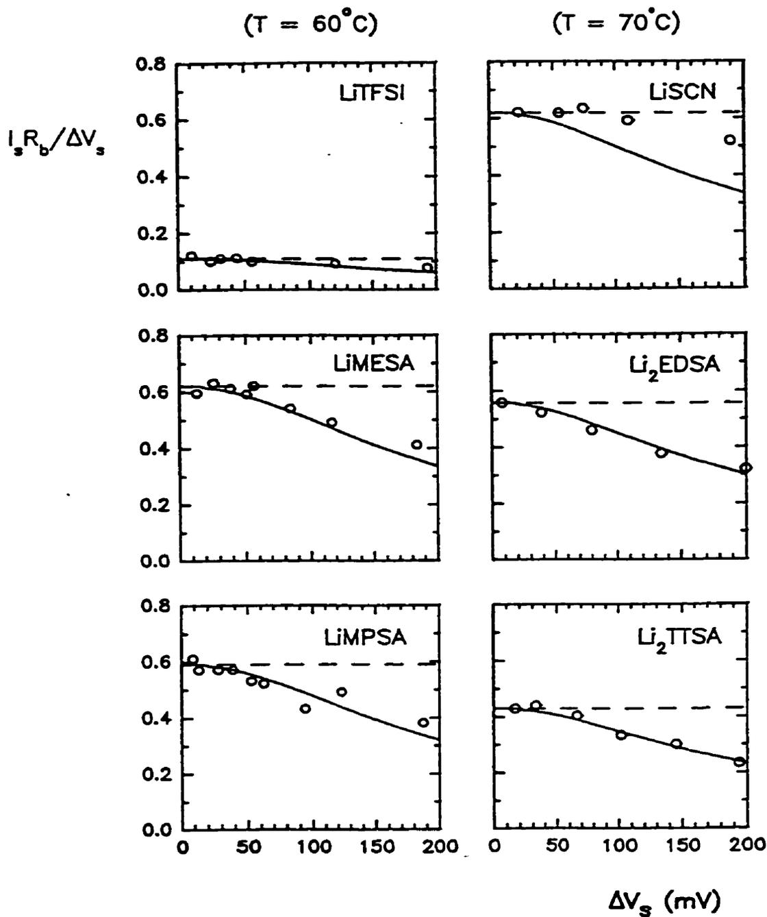
**Figure 2.2:** Variation du rapport  $I_s R_b / \Delta V_s$  en fonction de  $\Delta V_s$  pour les mélanges binaires de composition OE/Li = 30 examinés dans ce travail. Les courbes en trait plein ont été calculées à partir de l'équation (2.24) relative à un électrolyte fort idéal. Les diagrammes relatifs à LiTFSI, LiMESA et LiMPSA sont tirés de la thèse de Lascaud<sup>(28)</sup>.
