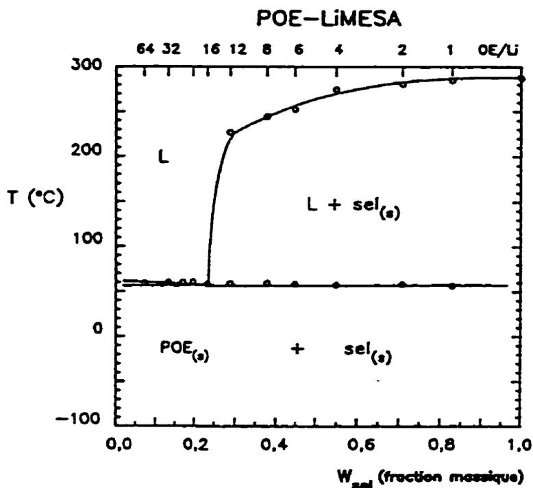
**Figure 1.10:** Diagramme d'état du système POE-LiMESA construit à partir des températures de fusion et de dissolution déterminées par DSC ou microscopie (pour le liquidus du sel).
