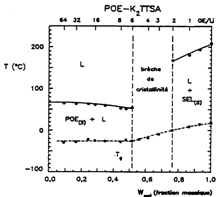
Figure 1.7: Diagramme d'état du système POE-K<sub>2</sub>TTSA construit à partir des températures de fusion et de dissolution déterminées par DSC. La courbe en traits hachurés représente la température de transition vitreuse de la phase amorphe présente dans tous les mélanges de ce système.
