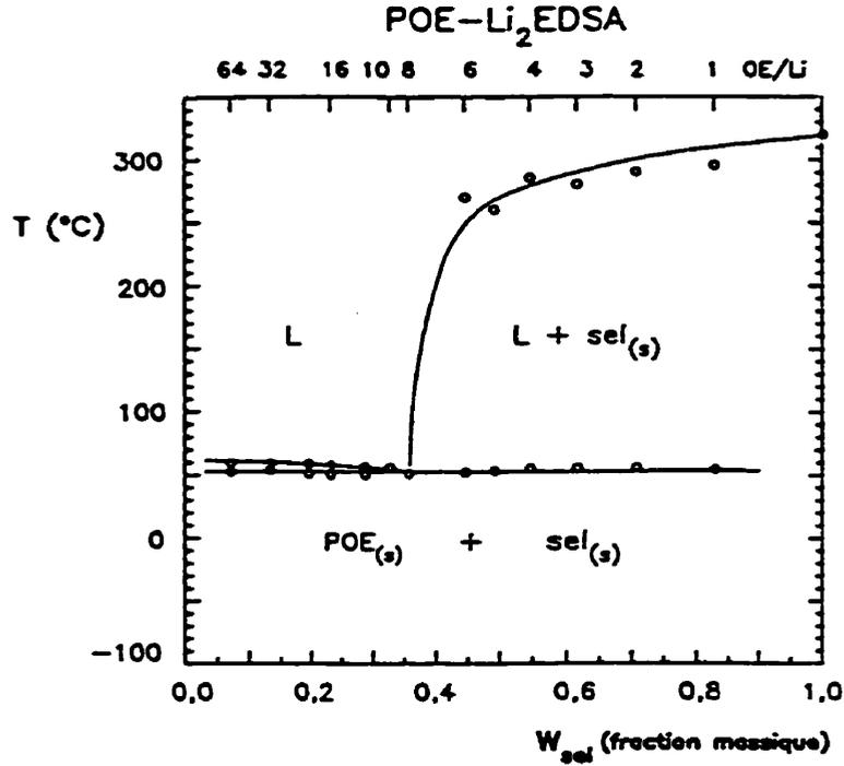
**Figure 1.12:** Diagramme d'état du système POE-Li<sub>2</sub>EDSA construit à partir des températures de fusion et de dissolution déterminées par DSC ou microscopie (pour le liquidus du sel).
