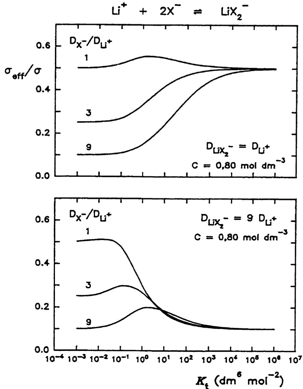
**Figure 2.5:** Courbes théoriques relatives à  $\sigma_{\text{eff}}/\sigma$  montrant l'effet de la constante de formation de triplets  $\text{LiX}_2^-$  dans un électrolyte polymère idéal pour divers rapports des coefficients de diffusion de chacune des espèces. D'après Lascaud *et al.*<sup>(22)</sup> pour une concentration  $C = 0,80 \text{ mol dm}^{-3}$  voisine de la composition  $\text{OE/Li} = 30$  des présents électrolytes.
