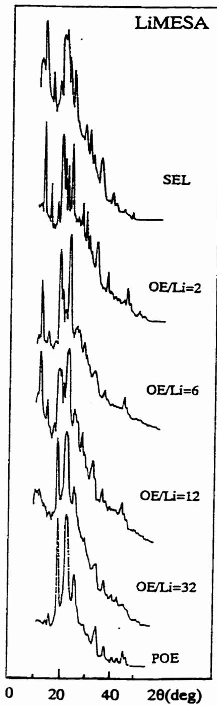
**Figure A.3:** Clichés de poudre obtenus par diffraction des rayons X pour divers mélanges du système POE-LIMESA montrant que seules les réflexions des constituants primaires sont observées.
