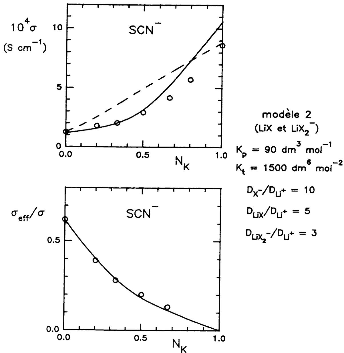
**Figure 2.7:** Courbes théoriques (en trait plein) obtenues avec le modèle 2 pour le système POE-LiSCN-KSCN. La courbe en traits hachurés est expliquée dans le texte.
