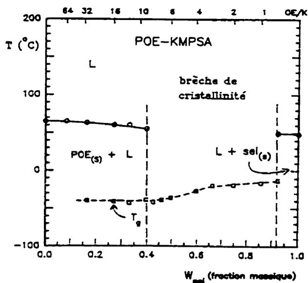
Figure 1.8: Diagramme d'état du système POE-KMPSA tel que rapporté par Lascaud et al. <sup>(40)</sup>.
