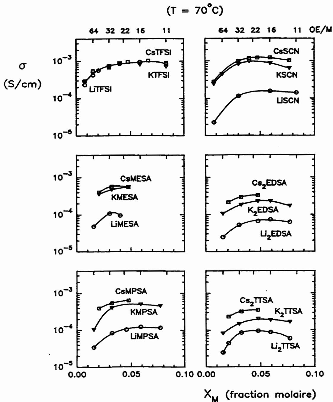
Figure 1.16: Comparaison des isothermes de conductivité des présents sels à 70 °C avec ceux rapportés par Besner<sup>(11)</sup> pour l'anion SCN<sup>-</sup> et par Vallée<sup>(12)</sup> et Perrier<sup>(42)</sup> pour l'anion TFSI.
