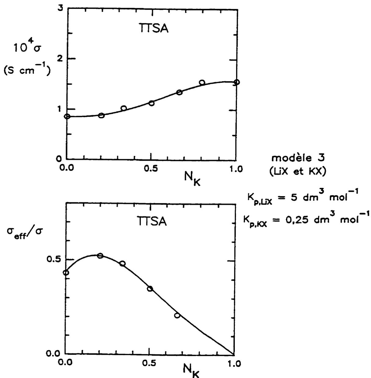
**Figure 2.12:** Courbes théoriques obtenues avec le modèle 3 pour le système POE-Li<sub>2</sub>TTSA-K<sub>2</sub>TTSA, en faisant appel aux ajustements variables des paramètres  $D_{\text{LiX}}/D_{\text{Li}^+}$  et  $D_{\text{X}^-}/D_{\text{Li}^+}$  décrits sur la figure 2.11.
