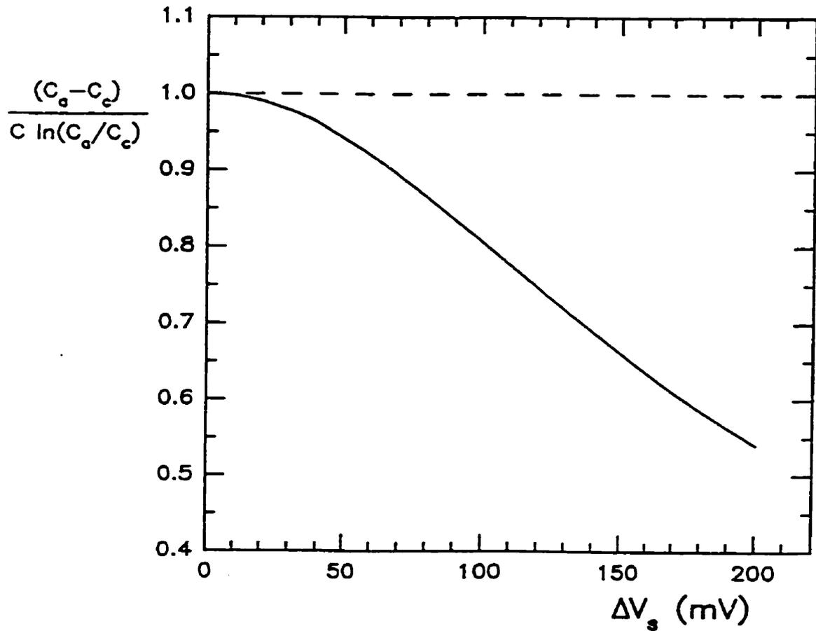
**Figure 2.1:** Variation de  $(C_s - C_e) / [C \ln(C_s / C_e)]$  en fonction du potentiel  $\Delta V_s$  appliqué à un électrolyte fort idéal dans une cellule symétrique Li/POE-LiX/Li. Courbe calculée à partir de l'équation (2.19) pour un état stationnaire caractérisé par un gradient de concentration linéaire tel que défini par l'équation (2.23).
