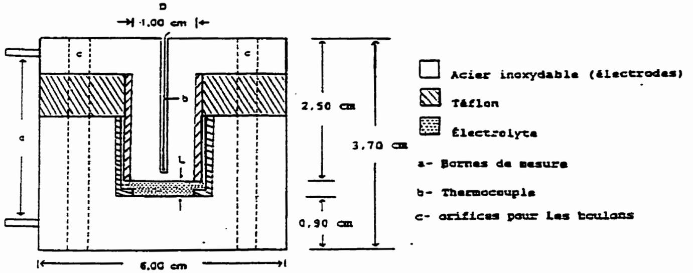
Figure A.4: Schéma de la cellule à conductivité utilisée dans ce travail.
