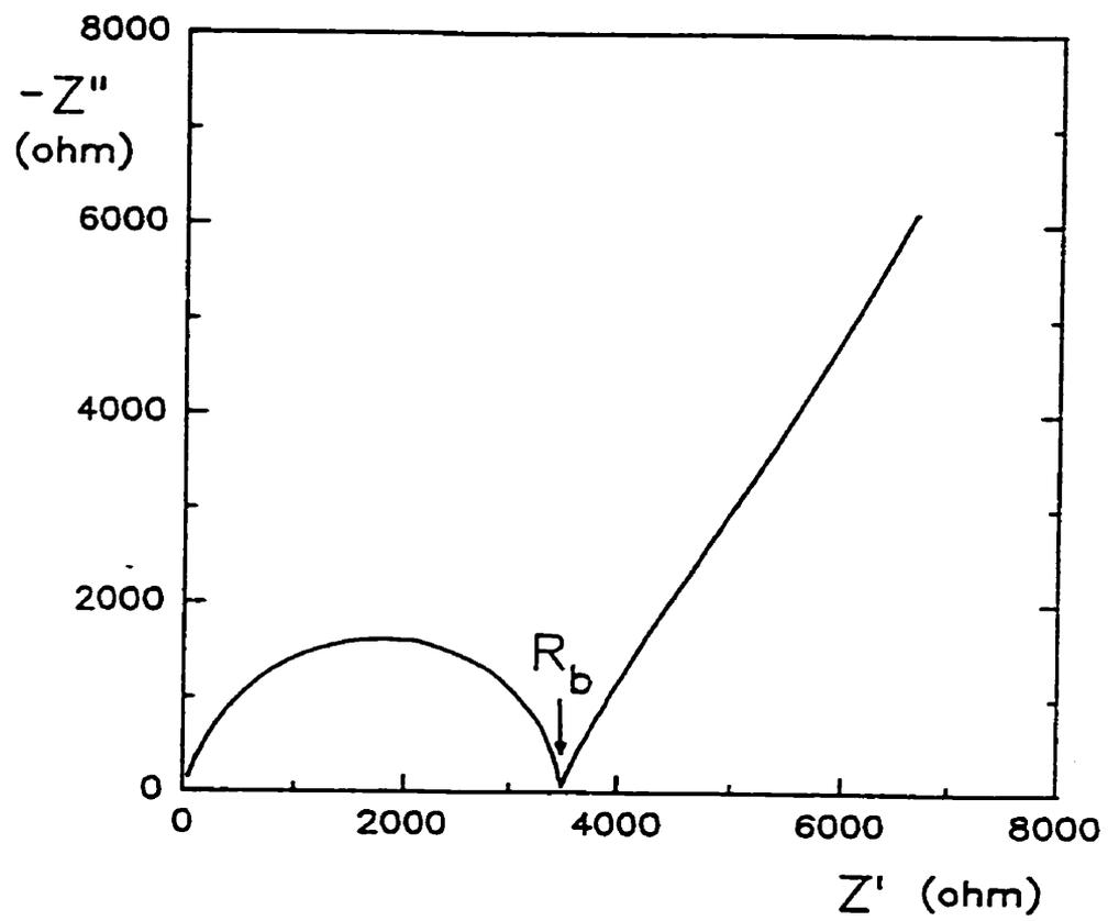
**Figure A.6:** Exemple d'un diagramme d'impédance complexe obtenu pour un mélange POE-Li<sub>2</sub>TTSA illustrant la méthode utilisée pour déterminer la résistance de  $R_b$  de l'électrolyte.
