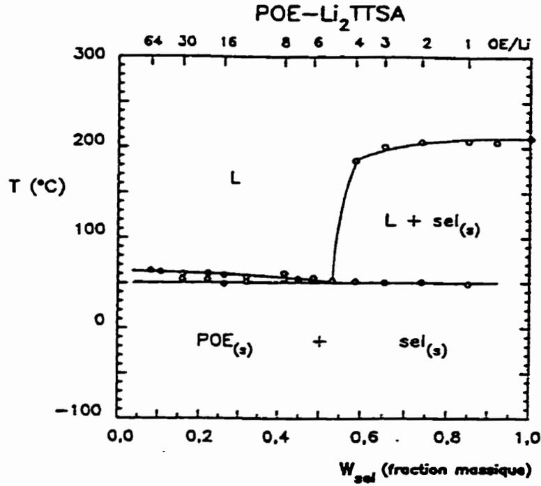
Figure 1.3: Diagramme d'état du système POE-Li<sub>2</sub>TTSA construit à partir des températures de fusion et de dissolution déterminées par DSC ou microscopie (pour le liquidus du sel).
