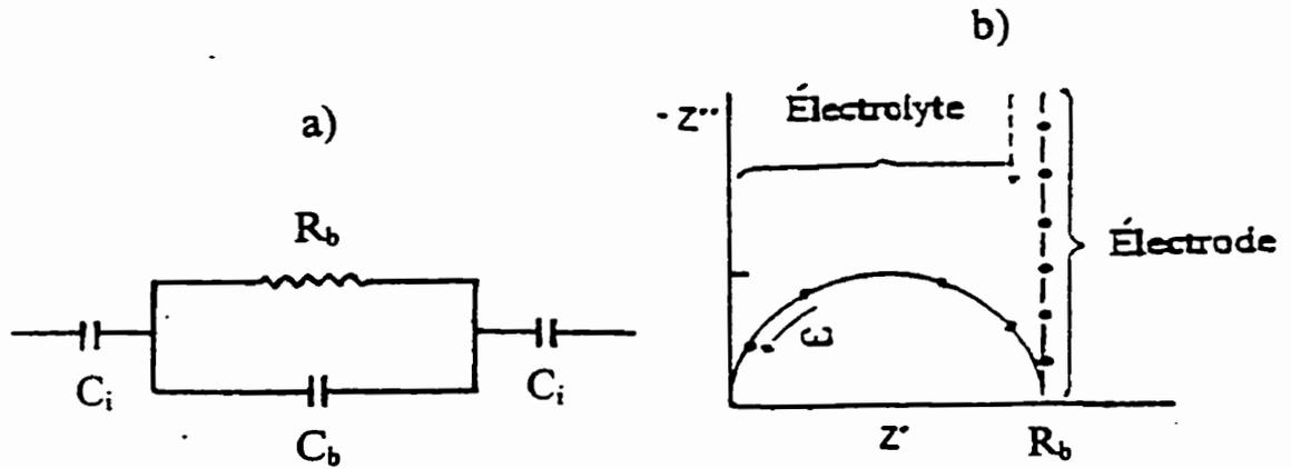
Figure A.5: Schéma du circuit équivalent d'une cellule à électrode bloquante (a) et du diagramme Cole-Cole correspondant (b).
