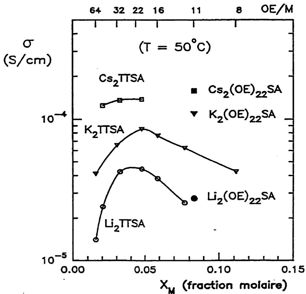
**Figure 1.17:** Comparaison des données de conductivité relatives au dianion TTSA avec celles relatives au dianion macromoléculaire  $(\text{OE})_{22}\text{SA}$  étudié par Tominaga *et al.*<sup>(37)</sup> en absence de tout POE additionnel, à 50 °C.
