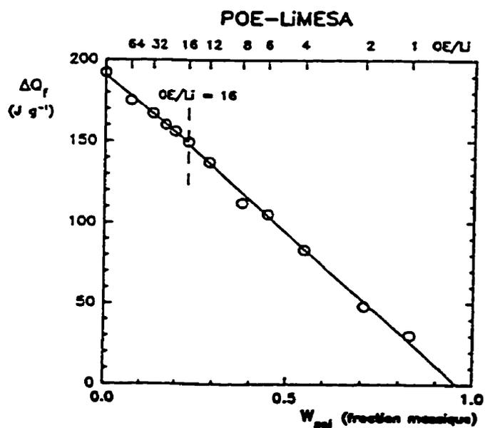
**Figure 1.11:** Système POE-LiMESA. Chaleurs de fusion de l'eutectique et du polymère en excès en fonction de la fraction massique en sel.
