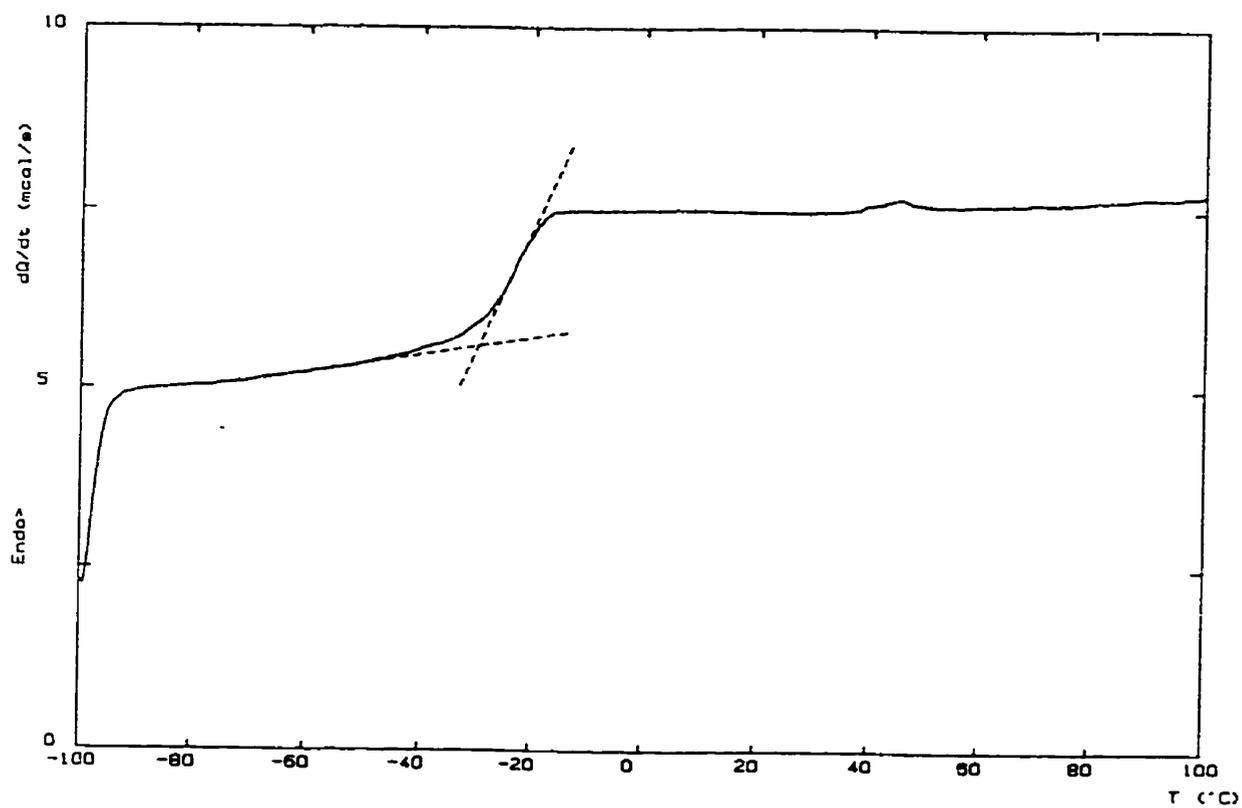
**Figure A.2:** Courbe de DSC illustrant la méthode utilisée pour déterminer la température de transition vitreuse dans ce travail.
