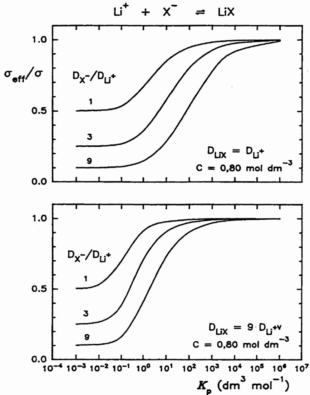
**Figure 2.4:** Courbes théoriques relatives à  $\sigma_{\text{eff}}/\sigma$  montrant l'effet de la constante de formation de paires d'ions LiX dans un électrolyte polymère idéal pour divers rapports des coefficients de diffusion de chacune des espèces. D'après Lascaud *et al.* <sup>(22)</sup> pour une concentration  $C = 0,80 \text{ mol dm}^{-3}$  voisine de la composition OE/Li = 30 des présents électrolytes.
