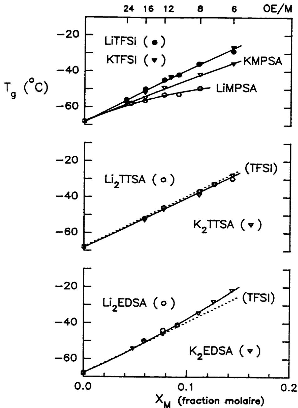
Figure 1.14: Variation de  $T_g$  avec la fraction molaire en cations par rapport aux motifs OE du polymère dans des mélanges surfondus impliquant  $\text{Li}_2\text{TTSA}$ ,  $\text{K}_2\text{TTSA}$ ,  $\text{Li}_2\text{EDSA}$  et  $\text{K}_2\text{EDSA}$ . Pour fins de comparaison, ce diagramme comporte des données similaires rapportées pour  $\text{LiMPSA}$ <sup>(40)</sup>,  $\text{KMPSA}$ <sup>(40)</sup>,  $\text{LiTFSI}$ <sup>(26)</sup> et  $\text{KTFSI}$ <sup>(40)</sup>.
