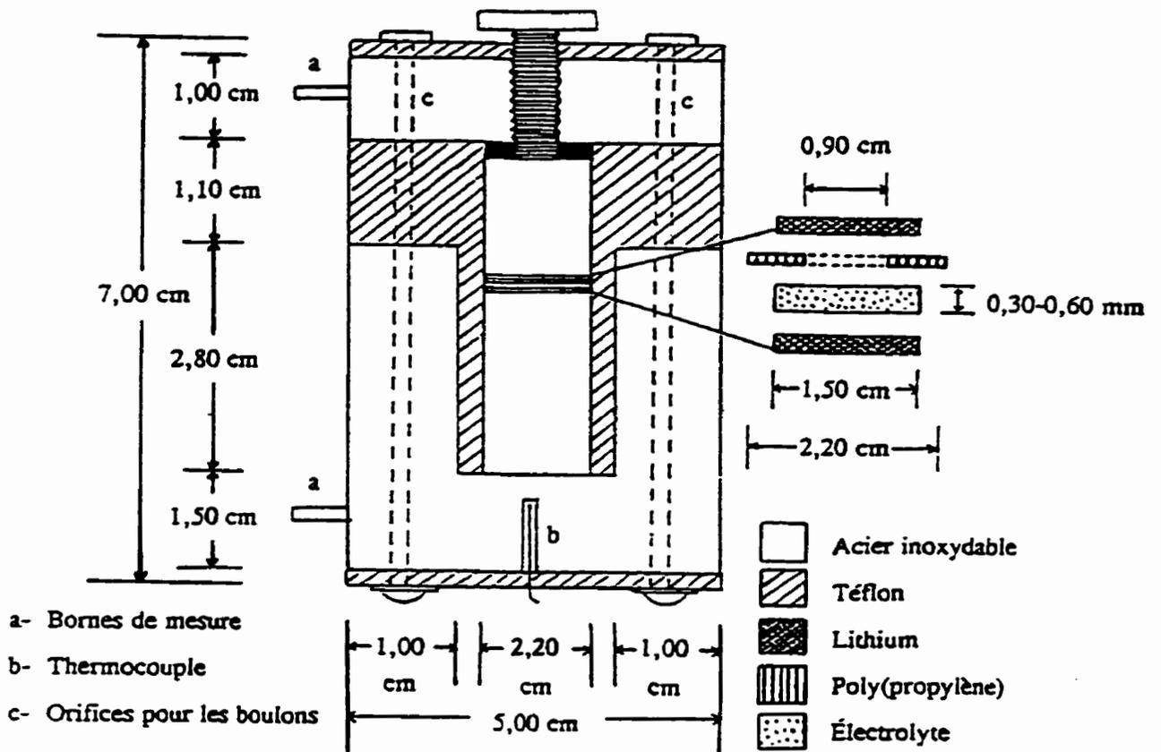
Figure A.7: Schéma de la cellule utilisée pour les expériences de polarisation dc.
