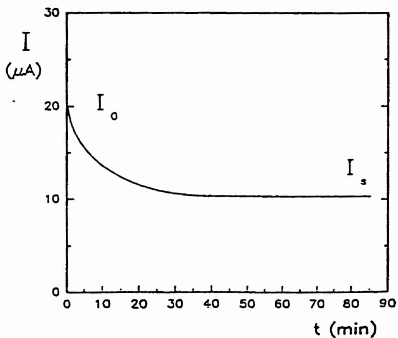
**Figure A.9:** Exemple de la décroissance du courant enregistré avec une cellule Li/POE-Li<sub>2</sub>TTSA/Li soumise à une polarisation de 20 mV.
