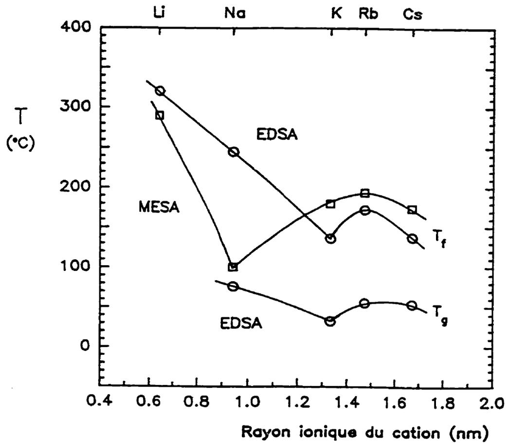
**Figure 1.9:** Température de fusion et  $T_g$  (lorsque mesurable) des sels alcalins relatifs aux anions EDSA et MESA présentés en fonction du rayon ionique des cations.
