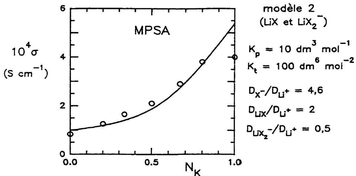
**Figure 2.8:** Courbe théorique obtenue avec le modèle 2 pour le système POE-LiMPSA-KMPSA.
