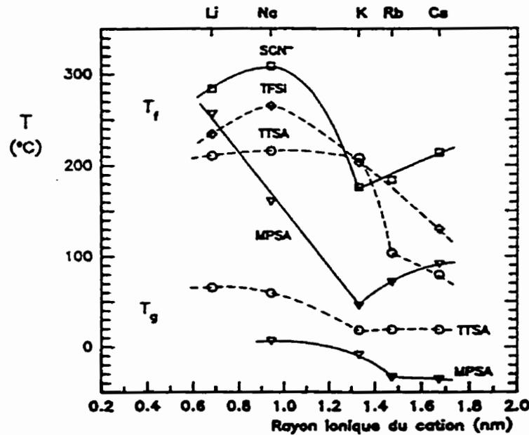
Figure 1.6: Température de fusion et  $T_g$  (lorsque mesurable) des sels alcalins relatifs aux anions MPSA, TFSI et  $\text{SCN}^-$  présentés en fonction du rayon ionique des cations. D'après Lascaud <sup>(28)</sup> pour MPSA, Vallée <sup>(12)</sup> et Perrier <sup>(42)</sup> pour TFSI, et Besner <sup>(11)</sup> pour  $\text{SCN}^-$ .
