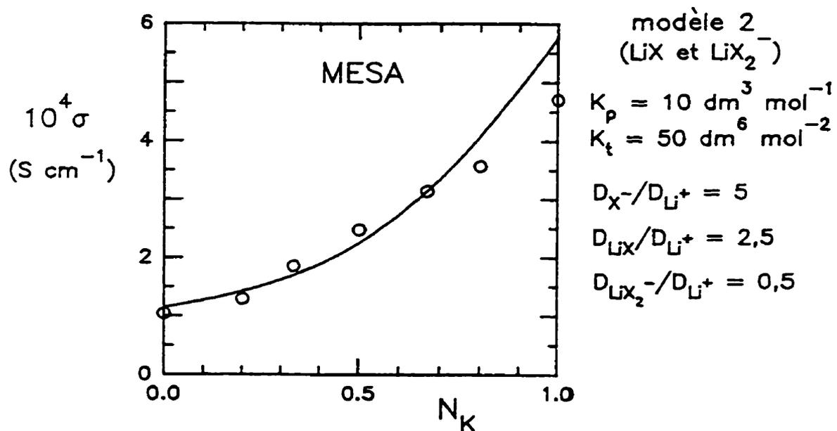
**Figure 2.9:** Courbe théorique obtenue avec le modèle 2 pour le système POE-LiMESA-KMESA.
