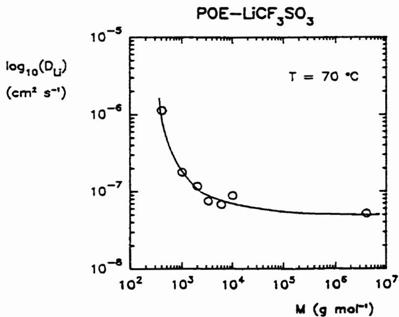
**Figure 1.2:** Effet de la masse molaire du POE sur le coefficient de diffusion du lithium dans des mélanges POE-LiCF<sub>3</sub>SO<sub>3</sub> de rapport molaire OE/Li = 20 à 90°C. D'après Shi et Vincent.<sup>(18)</sup>
