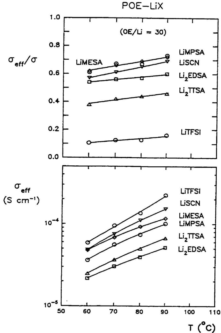
Figure 2.3: Effet de la température sur le rapport  $\sigma_{\text{eff}}/\sigma$  et sur  $\sigma_{\text{eff}}$  des systèmes binaires de composition OE/Li = 30 examinés dans ce travail. Les données relatives à LiTFSI, LiMESA et LiMPSA sont tirées de la thèse de Lascaud<sup>(28)</sup>.
