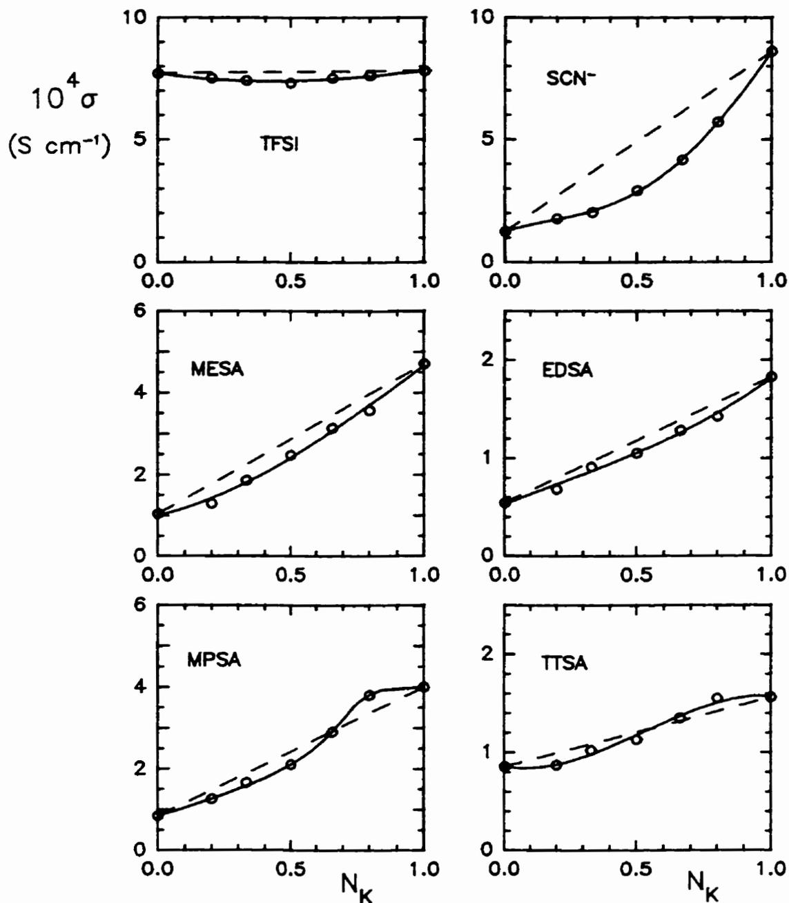
Figure 1.18: Isothermes de conductivité des systèmes ternaires de rapport molaire  $\text{OE}/(\text{Li}+\text{K}) = 30$ , à 70 °C, en fonction de la fraction molaire en cations potassium par rapport aux cations lithium ( $N_K$ ). D'après Perrier *et al.*<sup>(42,46)</sup> pour l'anion TFSI et Lascaud *et al.*<sup>(22,28)</sup> pour l'anion MPSA.
