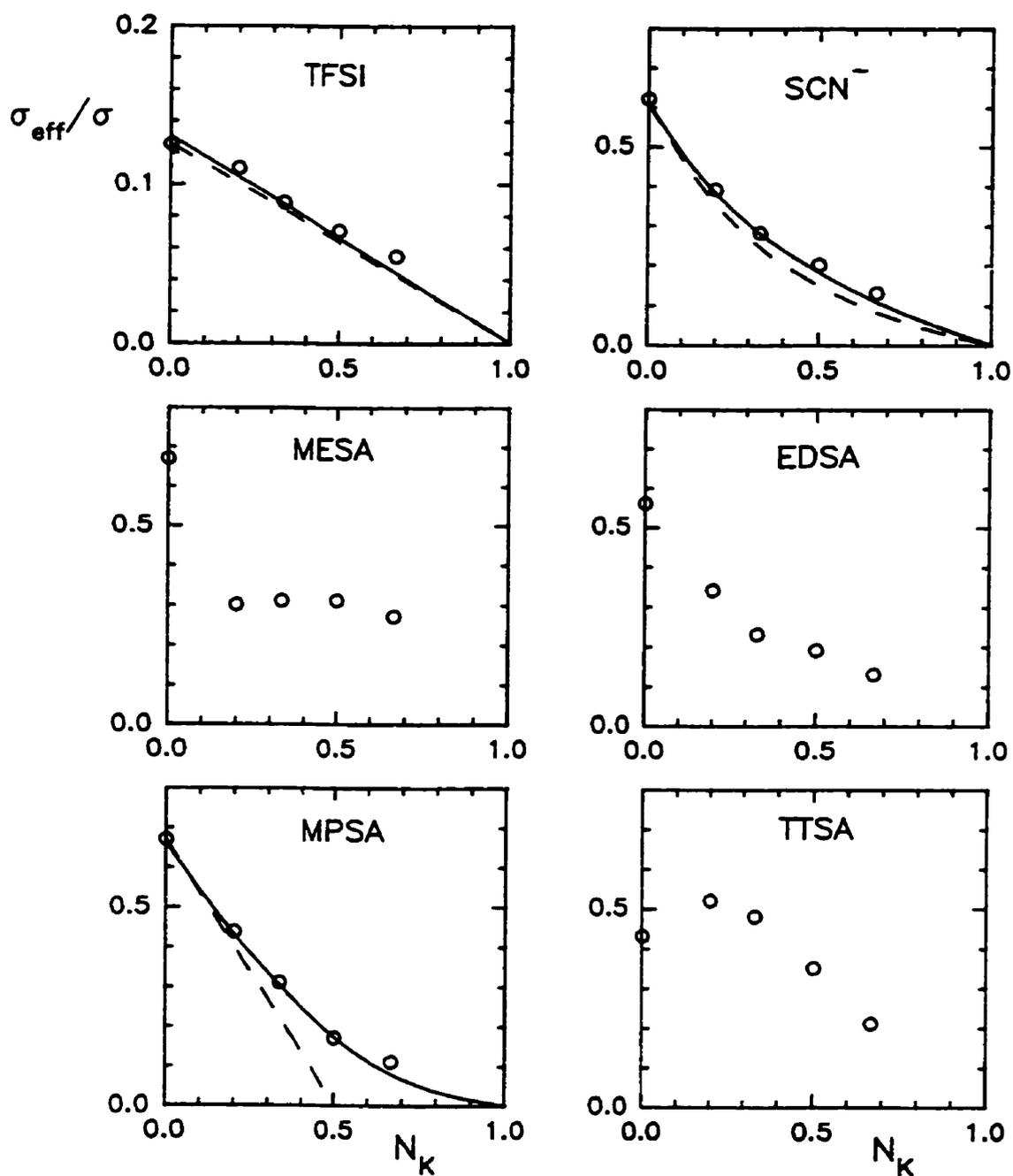
Figure 2.6: Regroupement des données de  $\sigma_{\text{eff}}/\sigma$  obtenues à 70 °C pour les mélanges POE-LiX-KX de composition OE/M = 30 examinés dans ce travail. Les diagrammes relatifs aux anions TFSI, SCN<sup>-</sup> et MPSA comportent des courbes théoriques qui sont expliquées dans le texte.
