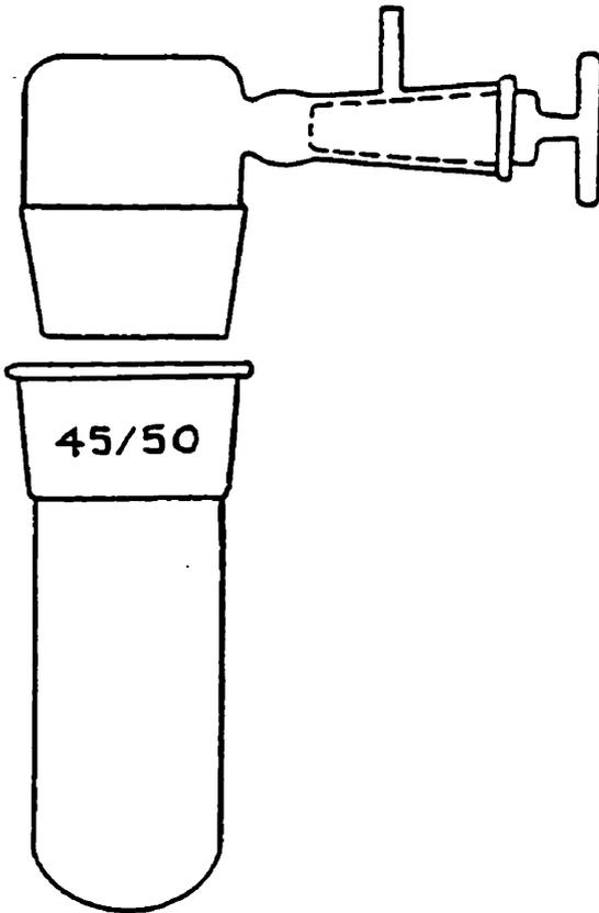
**Figure A.1:** Schéma des ampoules à vide utilisées pour le séchage des sels et pour la préparation et le séchage des mélanges POE-sel alcalin.
