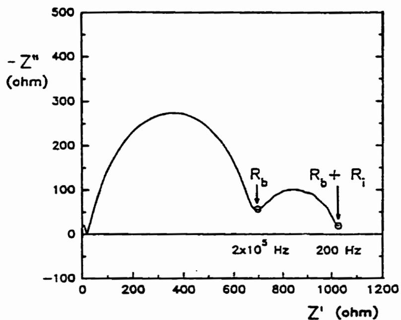
**Figure A.8:** Exemple d'un diagramme d'impédance complexe obtenu avec la cellule Li/POE-Li<sub>2</sub>TTSA/Li illustrant la procédure de détermination de  $R_b$  et  $R_i$ .
