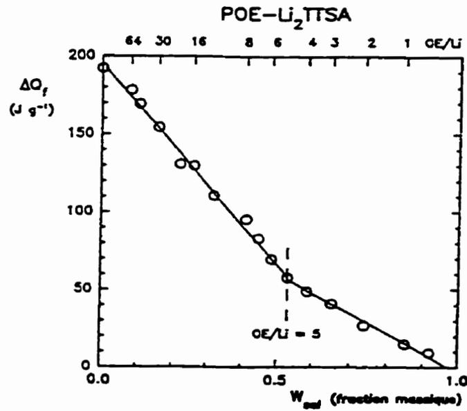
Figure 1.4: Système POE-Li<sub>2</sub>TTSA. Chaleurs de fusion de l'eutectique et du polymère en excès en fonction de la fraction massique en sel.
