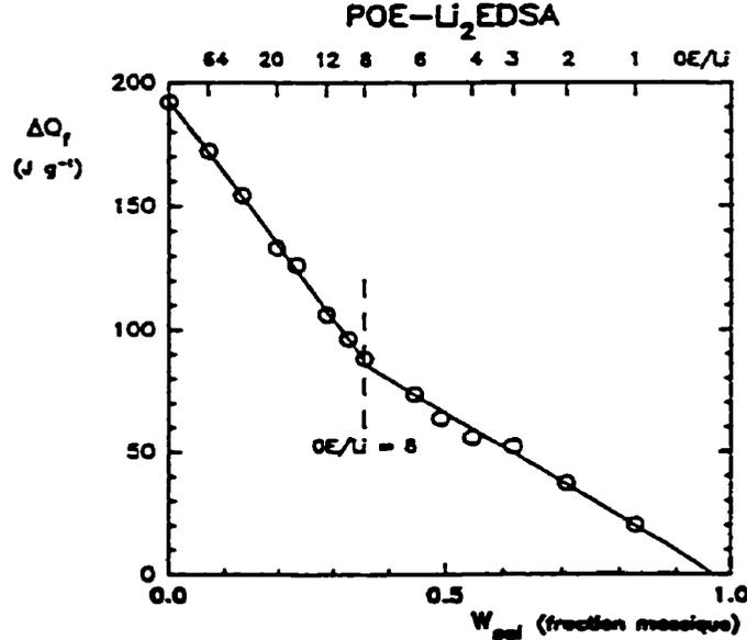
**Figure 1.13:** Système POE-Li<sub>2</sub>EDSA. Chaleurs de fusion de l'eutectique et du polymère en excès en fonction de la fraction massique en sel.
