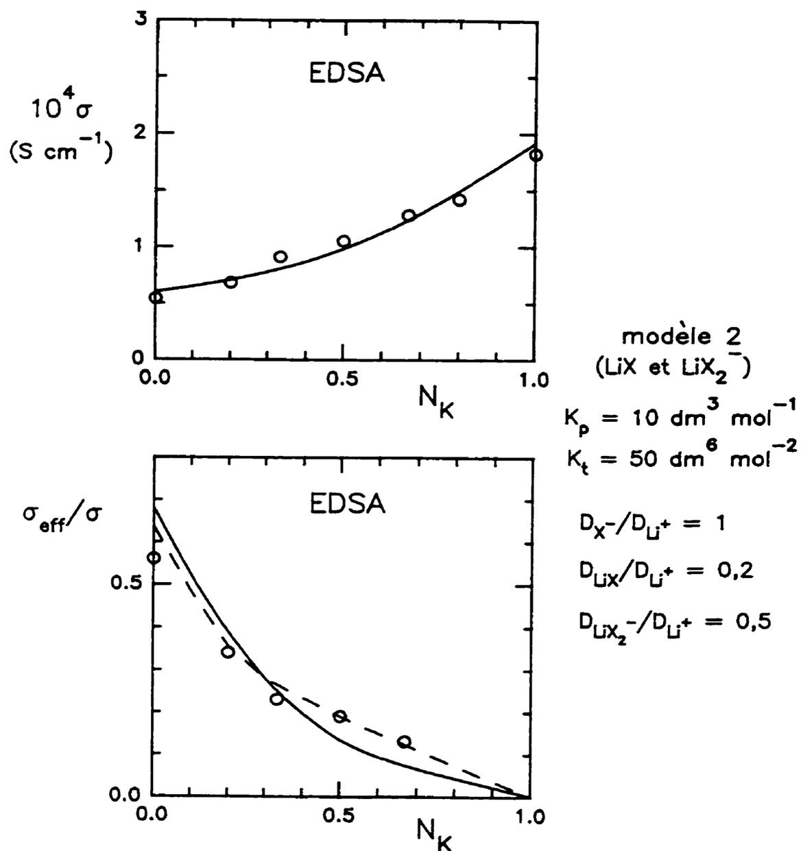
Figure 2.10: Courbes théoriques (en trait plein) obtenues avec le modèle 2 pour le système POE-Li<sub>2</sub>EDSA-K<sub>2</sub>EDSA. La courbe en traits hachurés a été obtenue en faisant appel à l'ajustement variable du paramètre  $D_{LiX}/D_{Li^+}$  décrit sur la figure 2.11.
