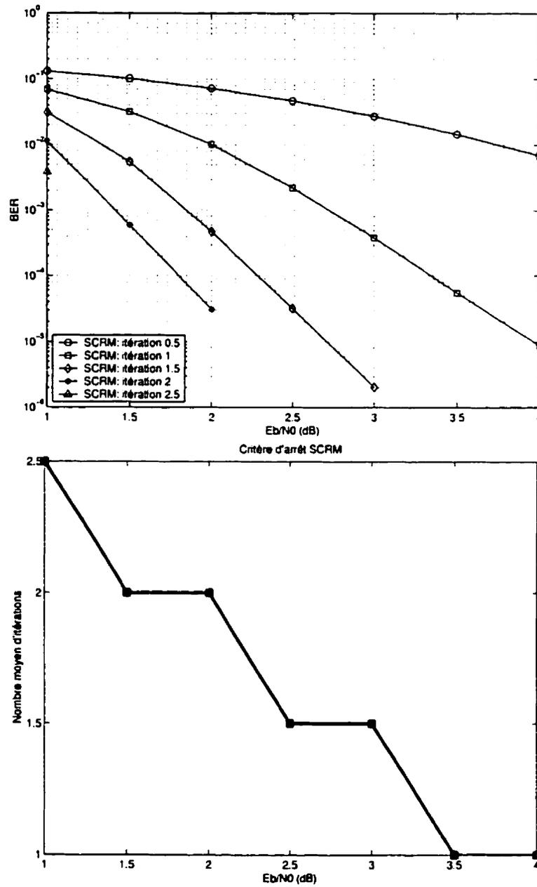
Figure 3.25: Performance du code turbo avec le critère d'arrêt SCRM dans un canal AWGN avec  $\frac{C^{n(i)}}{N} = 0.005$ ,  $K = 5$ ,  $G = (1, 35/23)$ ,  $R_{gp} = 1/3$  et taille d'entrelaceur aléatoire 900
