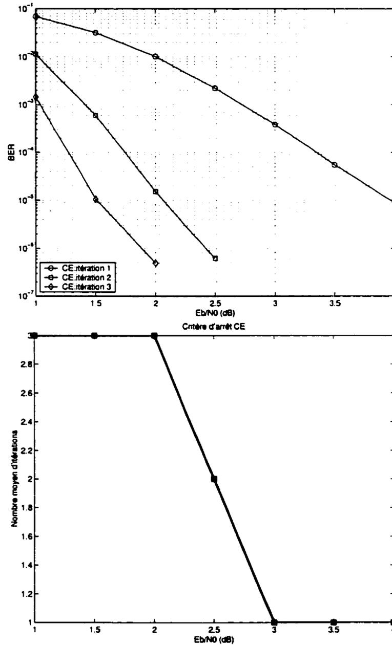
Figure 3.21: Performance du code turbo avec le critère d'arrêt CE dans un canal AWGN avec  $T_n(i)/T_2(1) = 10^{-4}$ ,  $K = 5$ ,  $G = (1, 35/23)$ ,  $R_{gp} = 1/3$  et taille d'entrelaceur aléatoire 900
