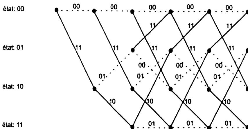
Figure 1.9: Treillis de l'encodeur de la figure 1.7
