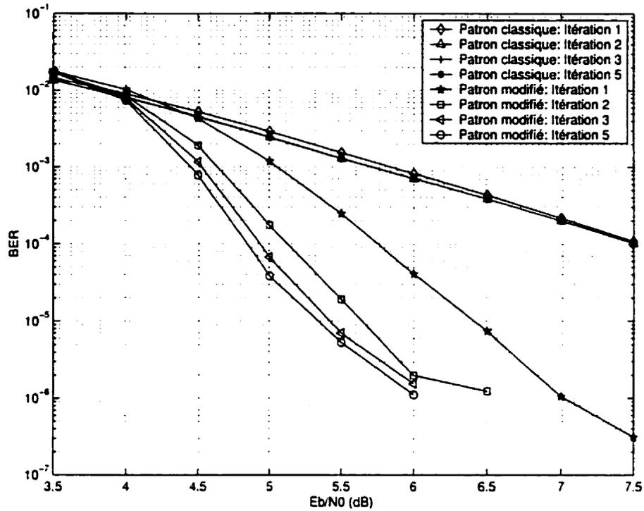
Figure IV.17: Performance des codes turbo avec les patrons de perforation classique et modifié dans un canal AWGN avec  $K = 4$ ,  $G = (1, 17/15)$ ,  $R_{gp} = 28/30$  et taille d'entrelaceur aléatoire 3600
