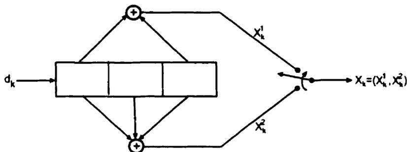
Figure 1.2: Codeur convolutionnel  $R = 1/2$ .
