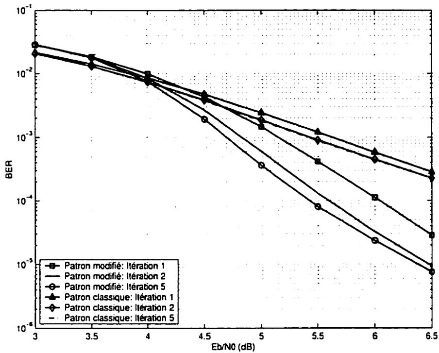
Figure IV.6: Performance des codes turbo avec les patrons de perforation classique et modifié dans un canal AWGN avec  $K = 3$ ,  $G = (1, 5/7)$ ,  $R_{gp} = 24/26$  et taille d'entrelaceur aléatoire 900
