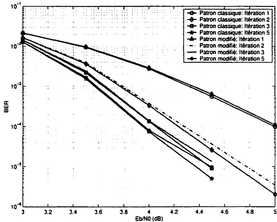
Figure 5.4: Comparaison entre l'ancienne et la nouvelle méthodes de perforation pour un taux de codage  $R_{gp} = 12/14$  dans un canal AWGN avec  $K = 5$ ,  $G = (1, \frac{31}{23})$ , taille d'entrelaceur aléatoire 1024
