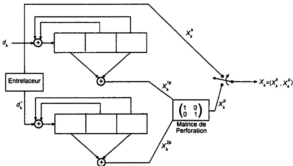
Figure 2.2: Schéma de principe d'un encodeur Turbo
