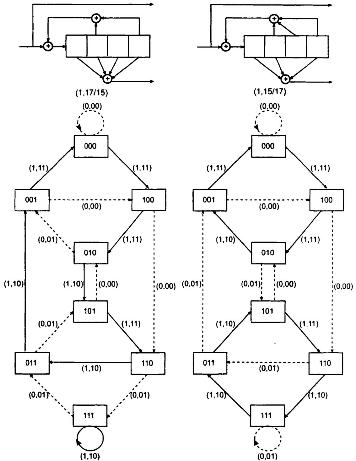
Figure 1.10: Diagrammes d'états des codeurs (1,17/15) et (1,15/17)
