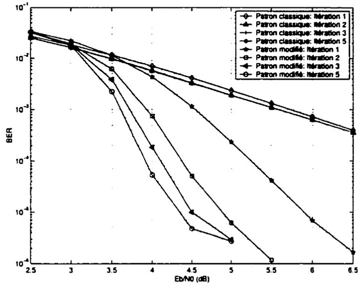
Figure IV.15: Performance des codes turbo avec les patrons de perforation classique et modifié dans un canal AWGN avec  $K = 4$ ,  $G = (1, 17/15)$ ,  $R_{gp} = 14/16$  et taille d'entrelaceur aléatoire 3600
