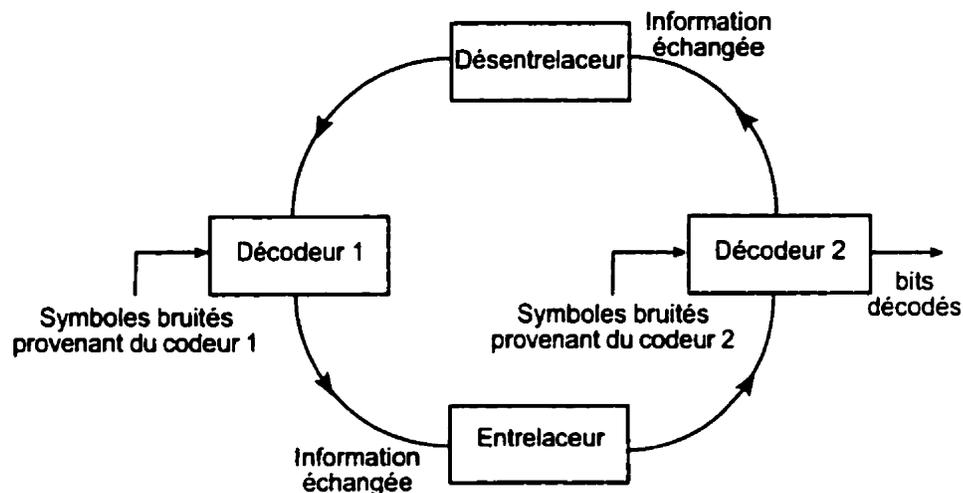
Figure 3.1: Schéma de principe du décodage itératif
