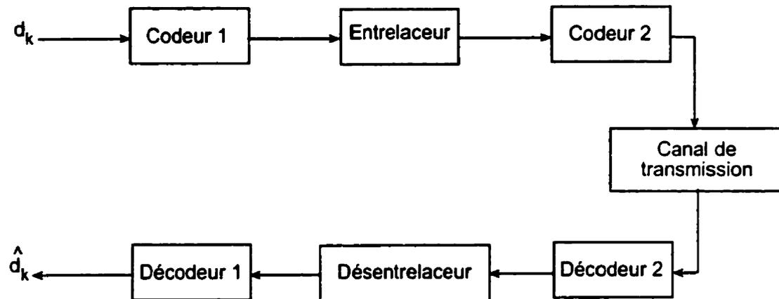
Figure 2.1: Schéma de principe d'une concaténation sérielle
