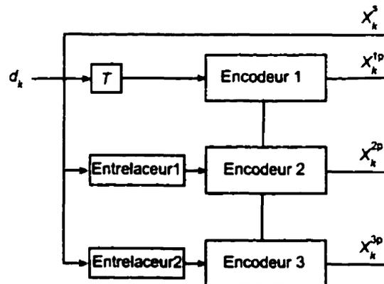
Figure 4.9: Encodeur Turbo avec 3 codeurs CRS
