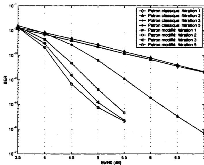
Figure IV.16: Performance des codes turbo avec les patrons de perforation classique et modifié dans un canal AWGN avec  $K = 4$ ,  $G = (1, 17/15)$ ,  $R_{gp} = 21/23$  et taille d'entrelaceur aléatoire 3600
