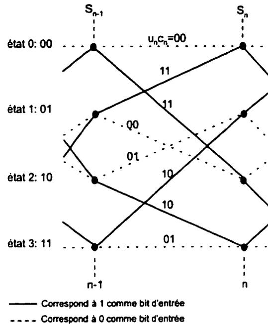
Figure II.2: Diagramme en treillis de la figure II.1
