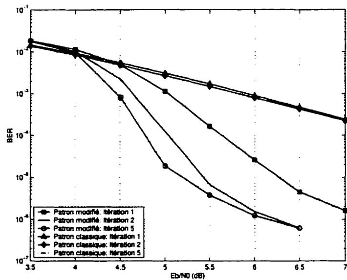
Figure IV.25: Performance des codes turbo avec les patrons de perforation classique et modifié dans un canal AWGN avec  $K = 5$ ,  $G = (1, 35/23)$ ,  $R_{gp} = 30/32$  et taille d'entrelaceur aléatoire 4096
