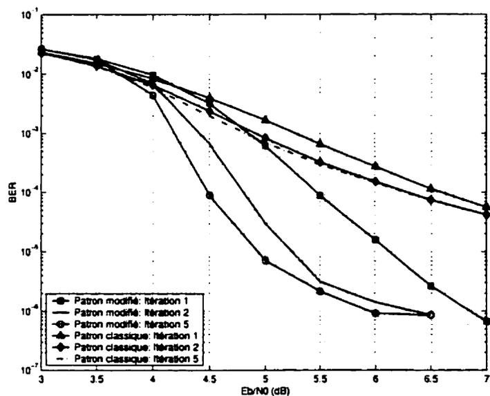
Figure IV.23: Performance des codes turbo avec les patrons de perforation classique et modifié dans un canal AWGN avec  $K = 5$ ,  $G = (1, 35/23)$ ,  $R_{gp} = 25/27$  et taille d'entrelaceur aléatoire 4096
