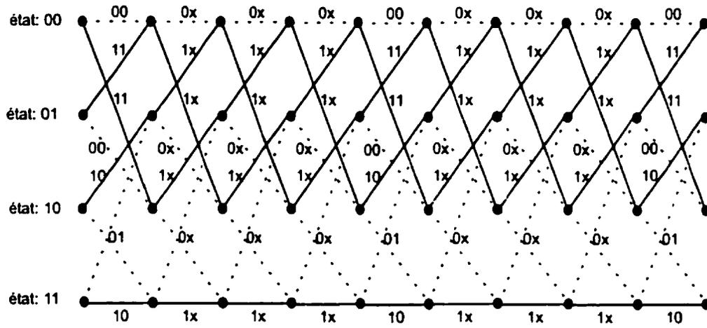
a) treillis du codeur CRS perforé utilisé par l'algorithme Log-MAP
