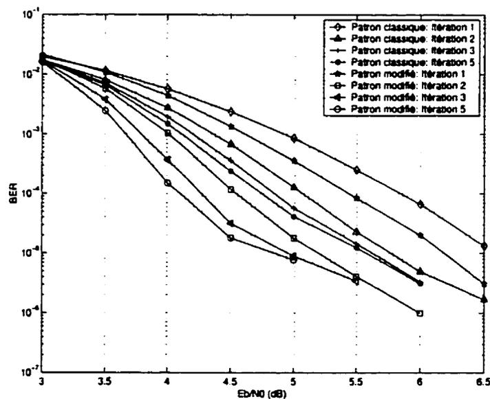
Figure IV.10: Performance des codes turbo avec les patrons de perforation classique et modifié dans un canal AWGN avec  $K = 4$ ,  $G = (1, 15/17)$ ,  $R_{gp} = 14/16$  et taille d'entrelaceur aléatoire 3600
