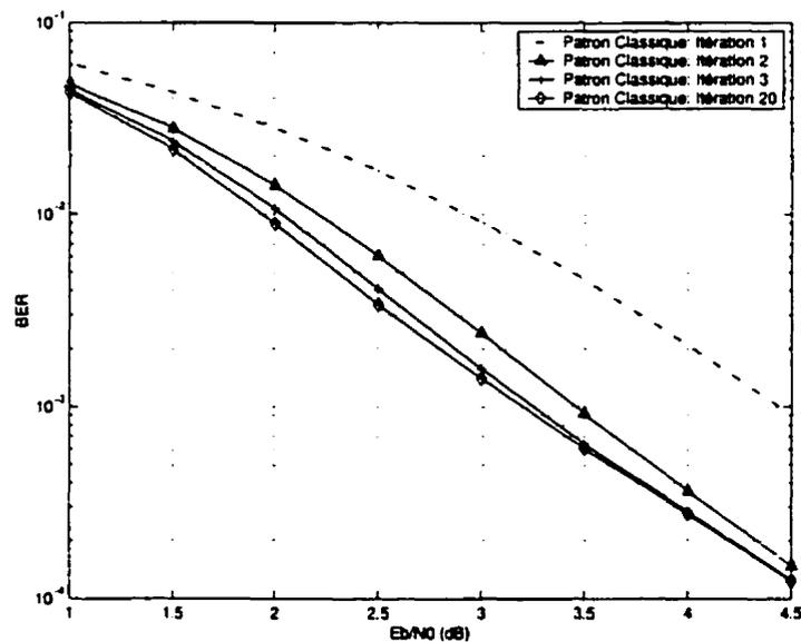
Figure 5.21: Influence du nombre d'itérations sur la performance des codes turbo perforés avec le patron classique dans un canal AWGN avec  $K = 3$ ,  $G = (1, 5/7)$ , canal AWGN,  $R_{gp} = 3/5$  et taille d'entrelaceur aléatoire 65536
