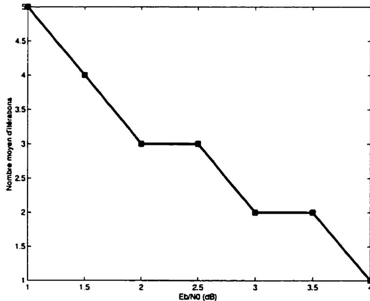
Figure 4.29: Nombre Moyen d'itérations du code turbo en mode parallèle utilisant le critère de la figure 4.28
