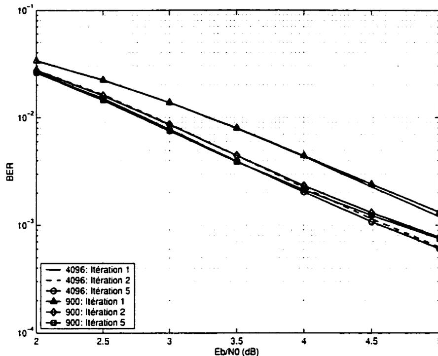
Figure 5.5: Performance des codes turbo utilisant un patron de perforation classique dans un canal AWGN avec  $K = 3$ ,  $G = (1, 5/7)$ ,  $R_{gp} = 6/8$  et tailles d'entrelaceur aléatoire 900 et 4096
