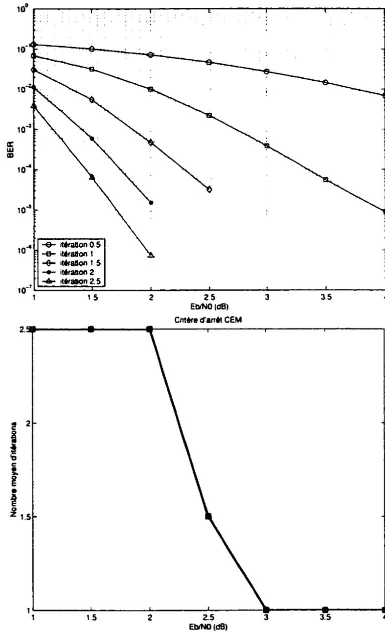
Figure 3.24: Performance du code turbo avec le critère d'arrêt CEM dans un canal AWGN avec  $T_n(i)/T_2(1) = 10^{-4}$ ,  $K = 5$ ,  $G = (1, 35/23)$ ,  $R_{gp} = 1/3$  et taille d'entrelaceur aléatoire 900
