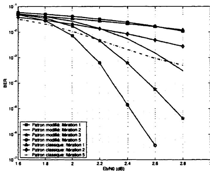
Figure IV.19: Performance des codes turbo avec les patrons de perforation classique et modifié dans un canal AWGN avec  $K = 5$ ,  $G = (1, 35/23)$ ,  $R_{gp} = 5/7$  et taille d'entrelaceur aléatoire 4096
