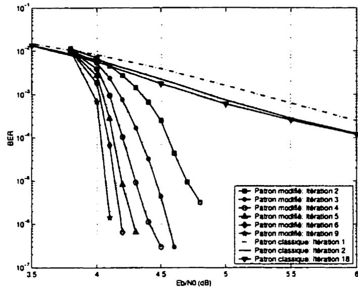
Figure IV.24: Performance des codes turbo avec les patrons de perforation classique et modifié dans un canal AWGN avec  $K = 5$ ,  $G = (1, 35/23)$ ,  $R_{gp} = 25/27$  et taille d'entrelaceur aléatoire 65536
