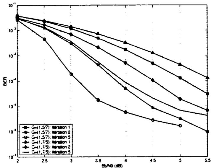
Figure 5.16: Influence du choix des codes élémentaires sur la performance des codes turbo perforés avec le patron modifié dans un canal AWGN avec  $K = 3$ ,  $R_{gp} = 6/8$  et taille de l'entrelaceur aléatoire 4096
