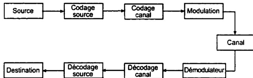
Figure 1: Diagramme d'un système de communication numérique
