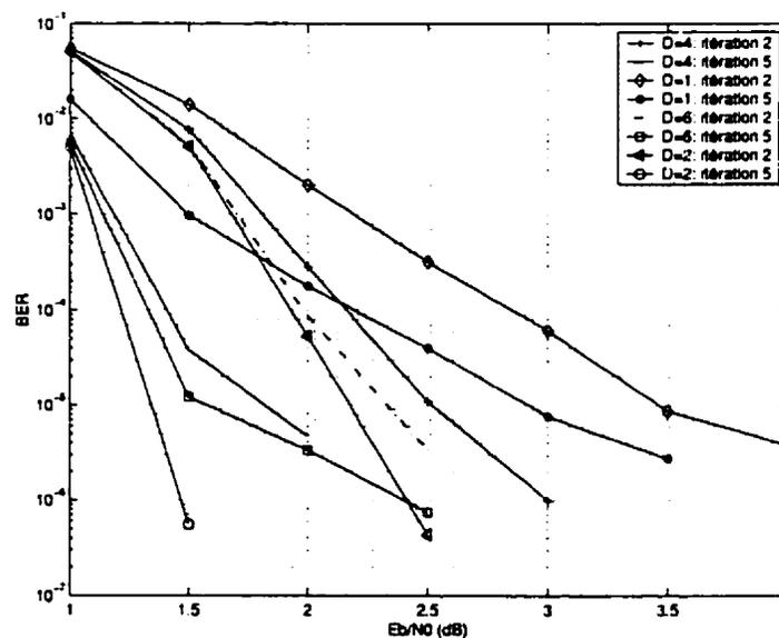
Figure III.1: Performance des codes turbo utilisant l'entrelaceur à double décalage cyclique de taille 3600 pour différentes valeurs de  $D$  dans un canal AWGN avec  $K = 5$ ,  $G = (1, 35/23)$ ,  $R_{gp} = 1/2$
