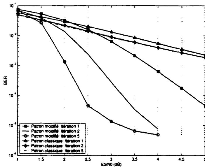
Figure IV.8: Performance des codes turbo avec les patrons de perforation classique et modifié dans un canal AWGN avec  $K = 4$ ,  $G = (1, 15/17)$ ,  $R_{gp} = 4/6$  et taille d'entrelaceur aléatoire 3600
