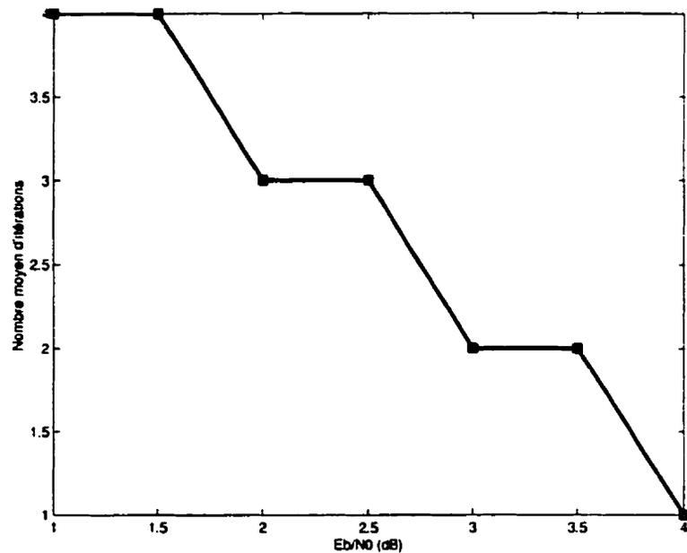
Figure 4.27: Nombre Moyen d'itérations du code turbo en mode parallèle utilisant le critère de la figure 4.26
