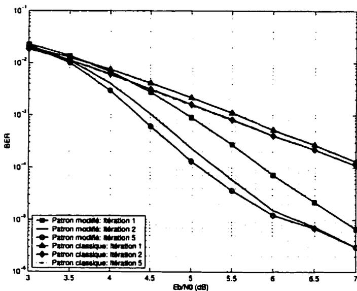
Figure IV.5: Performance des codes turbo avec les patrons de perforation classique et modifié dans un canal AWGN avec  $K = 3$ ,  $G = (1, 5/7)$ ,  $R_{gp} = 18/20$  et taille d'entrelaceur aléatoire 900
