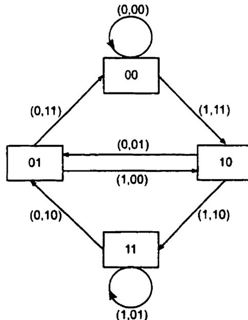
Figure 1.3: Diagramme d'état de l'encodeur de la figure 1.2
