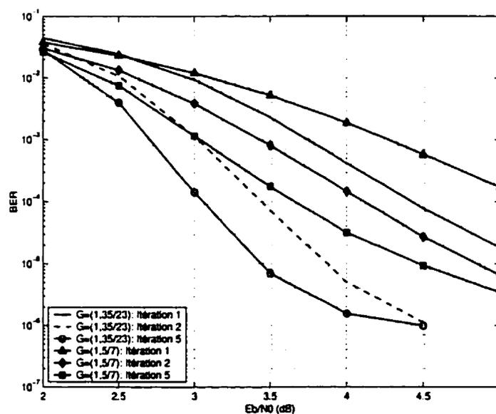
Figure 5.19: Performances des codes turbo perforés utilisant les patrons de perforation classique et modifié respectivement pour  $K = 5$ ,  $G = (1, 35/23)$  et  $K = 3$ ,  $G = (1, 5/7)$  dans canal AWGN avec  $R_{gp} = 6/8$  et taille d'entrelaceur aléatoire 900
