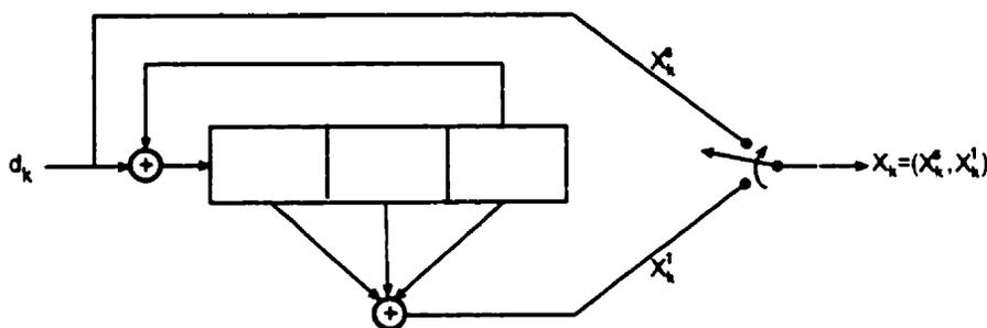
Figure 1.7: Codeur convolutionnel récuratif systématique  $R = 1/2$ ,  $K = 3$ ,  $G = [1, 7/5]$
