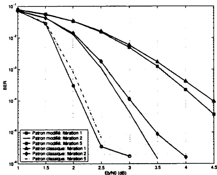
Figure 5.17: Performances des codes turbo perforés utilisant les patrons de perforation classique et modifié avec  $K = 4$ ,  $G = (1, 17/15)$ , canal AWGN,  $R_{gp} = 4/6$  et taille d'entrelaceur aléatoire 3600
