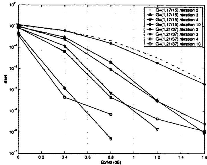
Figure 3.14: Influence du choix des codeurs CRS sur la performance du code turbo dans un canal AWGN avec  $R_{gp} = 1/3$  et taille de l'entrelaceur aléatoire 4096
