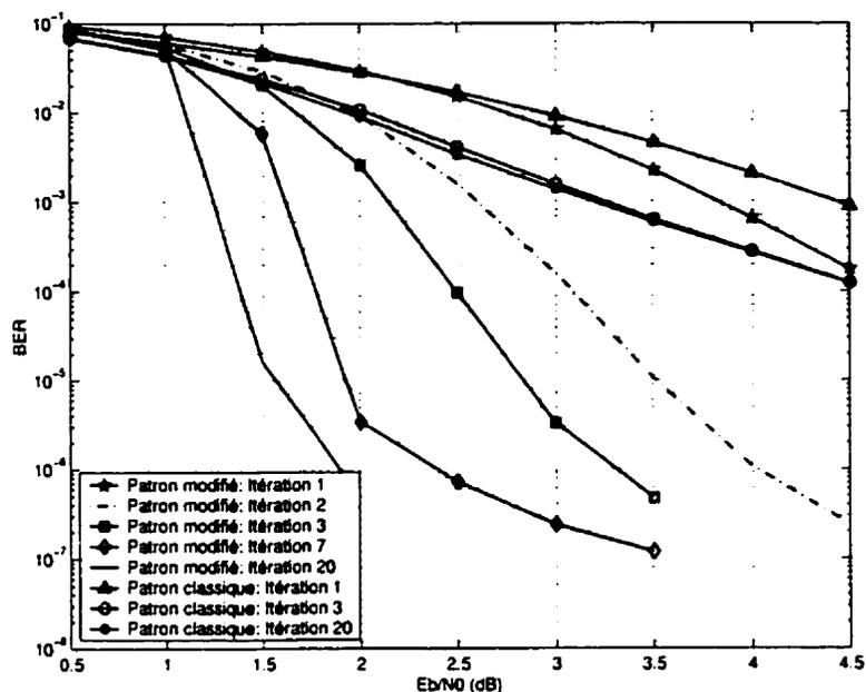
Figure 5.8: Performance des codes turbo avec les patrons de perforation classique et modifié dans un canal AWGN avec  $K = 3$ ,  $G = (1, 5/7)$ ,  $R_{gp} = 3/5$  et taille d'entrelaceur aléatoire 65536
