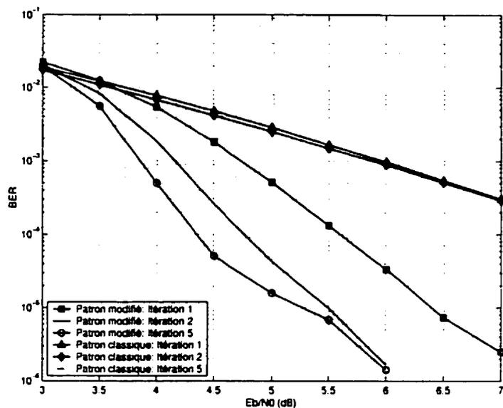
Figure IV.11: Performance des codes turbo avec les patrons de perforation classique et modifié dans un canal AWGN avec  $K = 4$ ,  $G = (1, 15/17)$ ,  $R_{gp} = 16/18$  et taille d'entrelaceur aléatoire 3600
