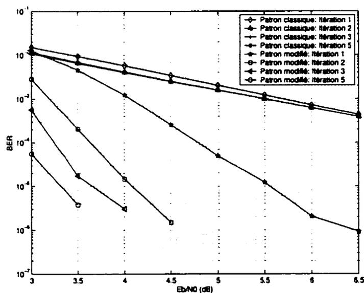
Figure IV.14: Performance des codes turbo avec les patrons de perforation classique et modifié dans un canal AWGN avec  $K = 4$ ,  $G = (1, 17/15)$ ,  $R_{gp} = 7/9$  et taille d'entrelaceur aléatoire 3600
