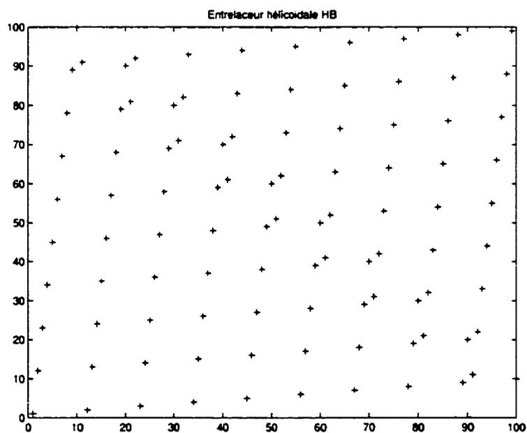
Figure I.6: Représentation matricielle de l'entrelaceur hélicoïdal HB
