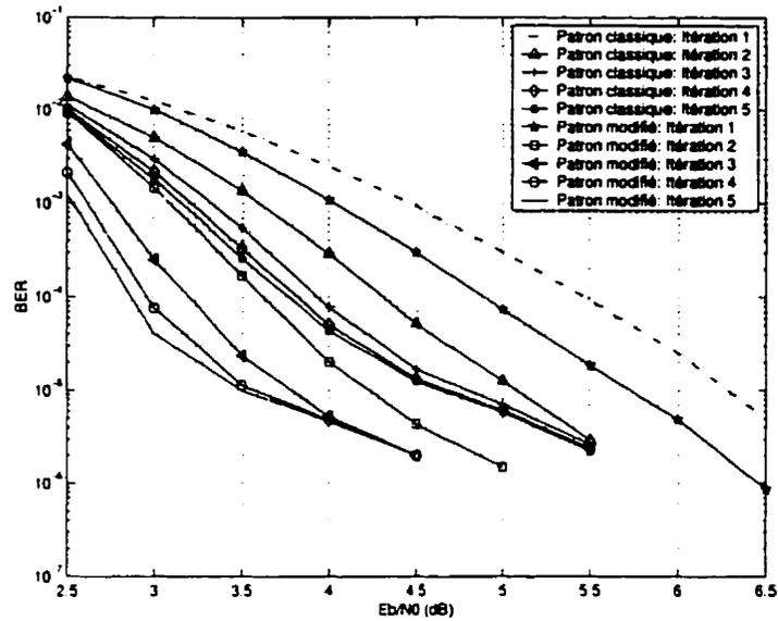
Figure IV.7: Performance des codes turbo avec les patrons de perforation classique et modifié dans un canal AWGN avec  $K = 4$ ,  $G = (1, 15/17)$ ,  $R_{gp} = 6/8$  et taille d'entrelaceur aléatoire 3600
