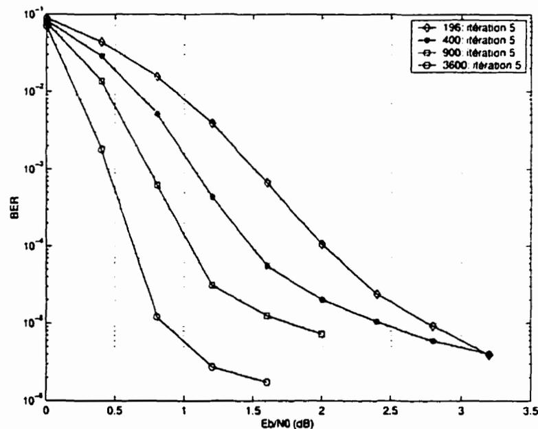
Figure 3.4: Influence de la taille de l'entrelaceur aléatoire sur la performance des codes turbo dans un canal AWGN avec  $K = 5$ ,  $G = (1, 21/37)$  et  $R_{gp} = 1/3$
