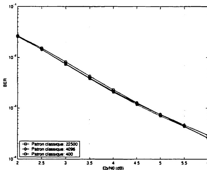
Figure 5.14: Influence de la taille de l'entrelaceur aléatoire sur la performance des codes turbo perforés avec le patron classique: 5ème itération,  $K = 3$ ,  $G = (1, 5/7)$ , canal AWGN,  $R_{gp} = 6/8$
