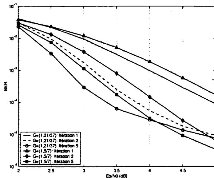
Figure 5.18: Performances des codes turbo perforés utilisant les patrons de perforation classique et modifié respectivement pour  $K = 5$ ,  $G = (1, 21/37)$  et  $K = 3$ ,  $G = (1, 5/7)$  dans canal AWGN avec  $R_{gp} = 6/8$  et taille d'entrelaceur aléatoire 900
