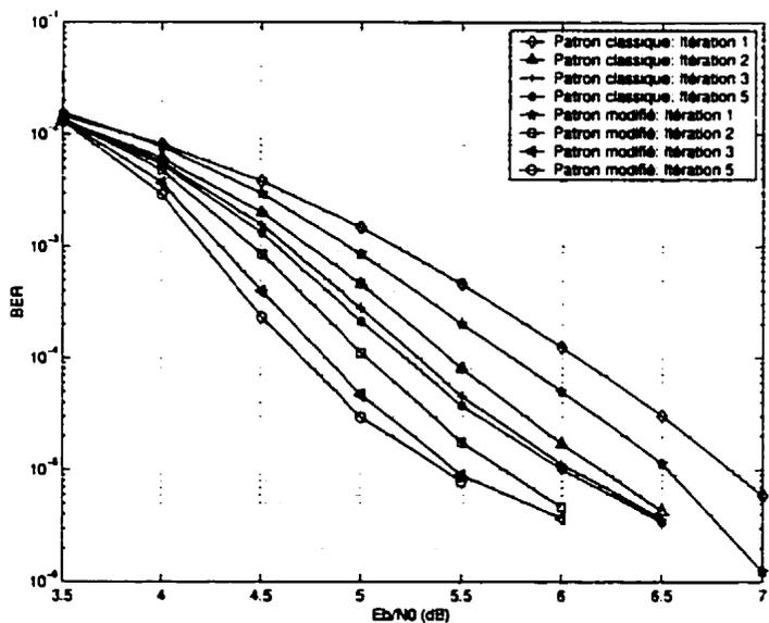
Figure IV.12: Performance des codes turbo avec les patrons de perforation classique et modifié dans un canal AWGN avec  $K = 4$ ,  $G = (1, 15/17)$ ,  $R_{gp} = 22/24$  et taille d'entrelaceur aléatoire 3600
