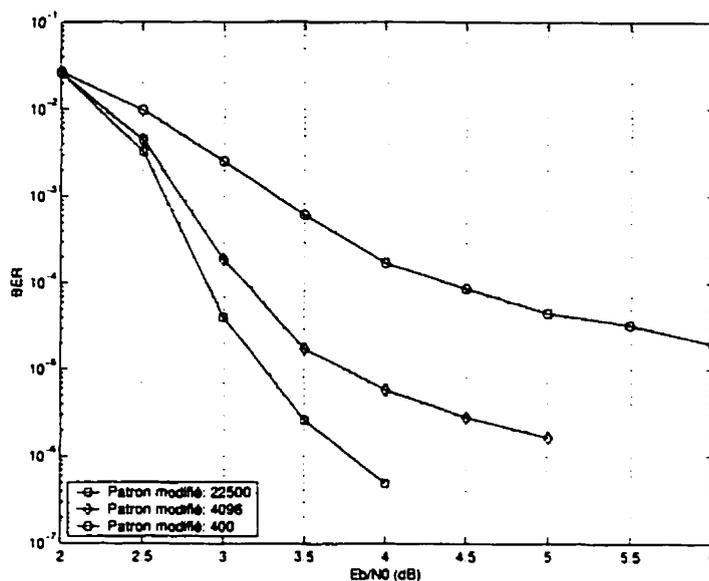
Figure 5.15: Influence de la taille de l'entrelaceur aléatoire sur la performance des codes turbo perforés avec le patron modifié: 5<sup>ème</sup> itération,  $K = 3$ ,  $G = (1, 5/7)$ , canal AWGN,  $R_{gp} = 6/8$
