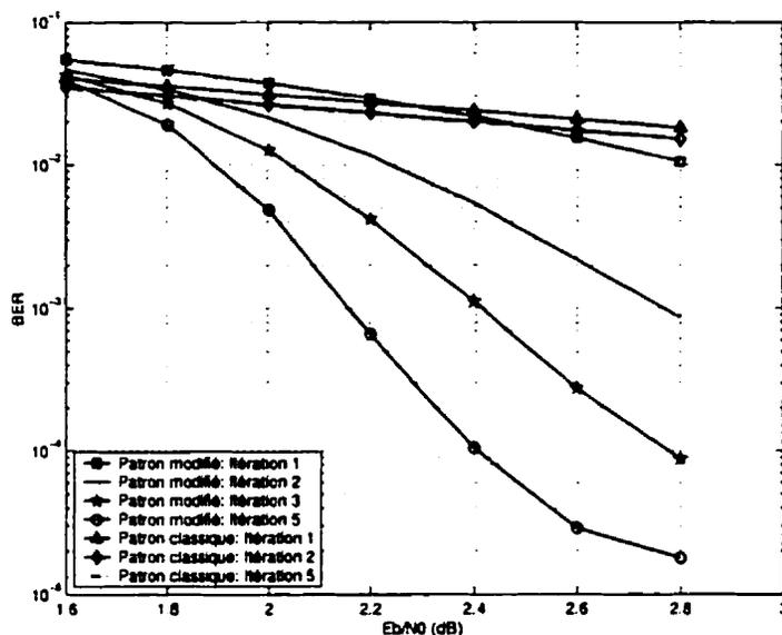
Figure IV.18: Performance des codes turbo avec les patrons de perforation classique et modifié dans un canal AWGN avec  $K = 5$ ,  $G = (1, 21/37)$ ,  $R_{gp} = 5/7$  et taille d'entrelaceur aléatoire 4096
