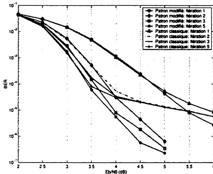
Figure IV.20: Comparaison entre l'ancienne et la nouvelle méthode de perforation pour un taux de codage  $R_{gp} = 8/10$  dans un canal AWGN avec  $K = 5$ ,  $G = (1, \frac{35}{23})$ , taille d'entrelaceur aléatoire = 1024
