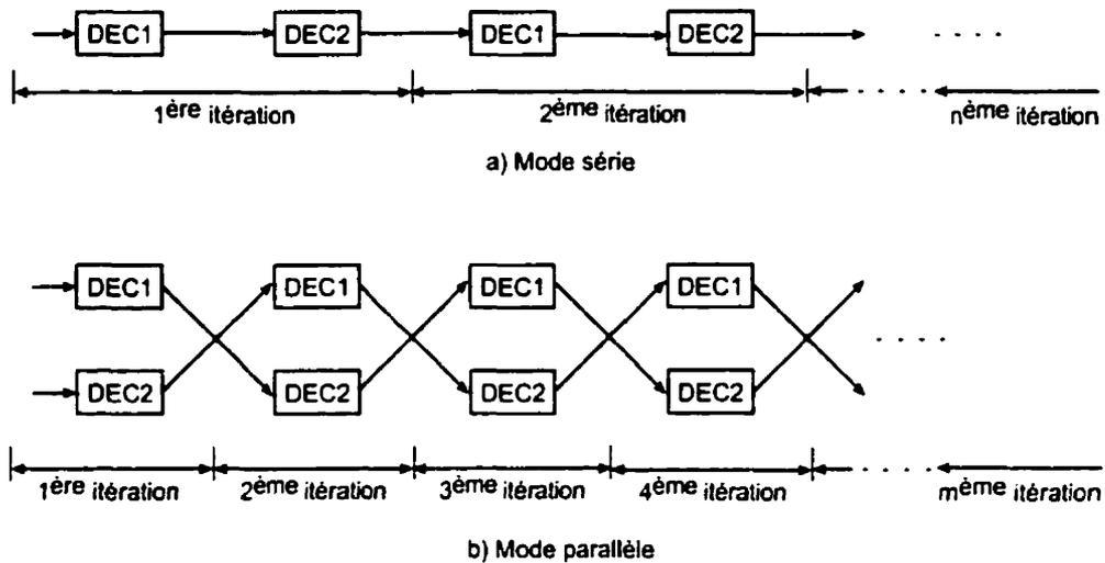
Figure 4.6: Structure de décodage turbo en modes série et parallèle
