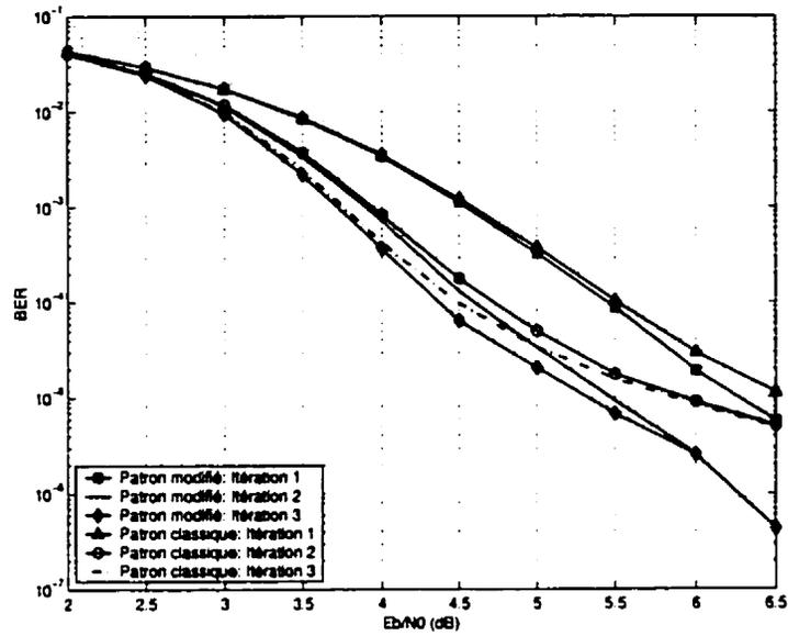
Figure IV.2: Performance des codes turbo avec les patrons de perforation classique et modifié dans un canal AWGN avec  $K = 3$ ,  $G = (1, 5/7)$ ,  $R_{gp} = 10/12$  et taille d'entrelaceur aléatoire 900
