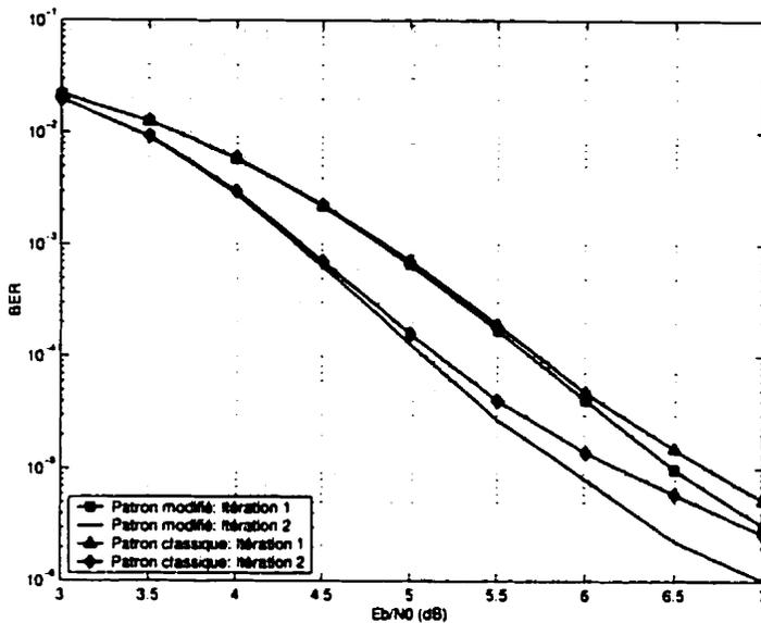
Figure IV.4: Performance des codes turbo avec les patrons de perforation classique et modifié dans un canal AWGN avec  $K = 3$ ,  $G = (1, 5/7)$ ,  $R_{gp} = 16/18$  et taille d'entrelaceur aléatoire 900
