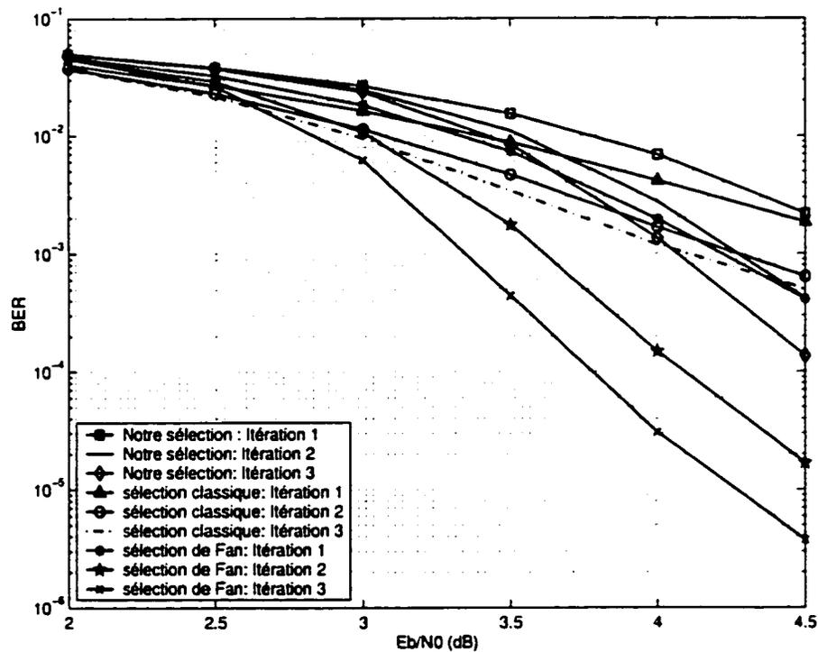
Figure 5.2: Performances des codes turbo perforés dans un canal AWGN avec  $R_{gp} = 10/12$ ,  $K = 5$ ,  $G = (1, \frac{35}{23})$  et taille d'entrelaceur aléatoire 1024: Résultats de simulation correspondants aux tableaux 5.1, 5.2 et 5.3
