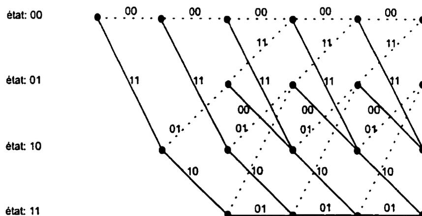
Figure 1.5: Treillis de l'encodeur de la figure 1.2
