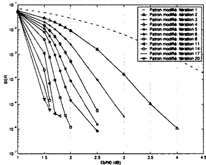
Figure 5.22: Influence du nombre d'itérations sur la performance des codes turbo perforés avec le patron modifié dans un canal AWGN avec  $K = 3$ ,  $G = (1, 5/7)$ , canal AWGN,  $R_{gp} = 3/5$  et taille d'entrelaceur aléatoire 65536
