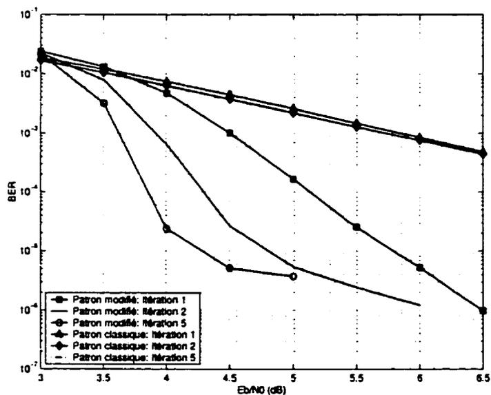
Figure IV.21: Performance des codes turbo avec les patrons de perforation classique et modifié dans un canal AWGN avec  $K = 5$ ,  $G = (1, \frac{35}{23})$ ,  $R_{gp} = 15/17$  et taille d'entrelaceur aléatoire 4096
