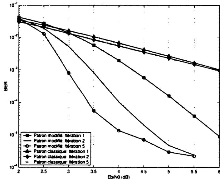
Figure IV.9: Performance des codes turbo avec les patrons de perforation classique et modifié dans un canal AWGN avec  $K = 4$ ,  $G = (1, 15/17)$ ,  $R_{gp} = 8/10$  et taille d'entrelaceur aléatoire 3600
