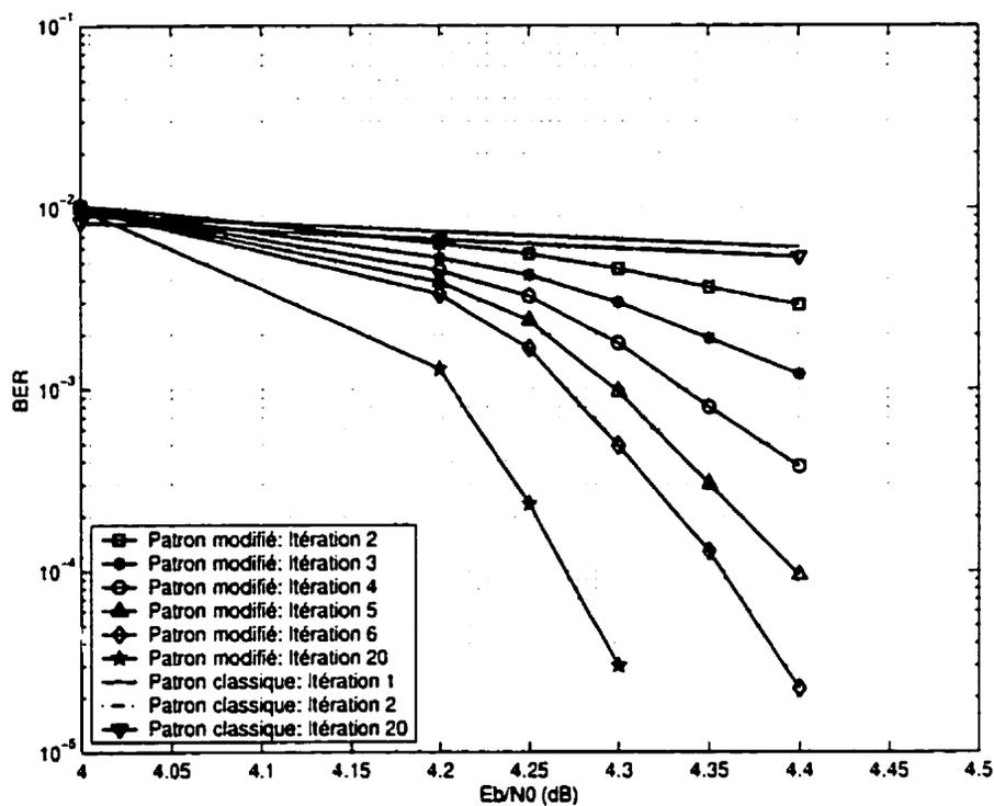
Figure IV.26: Performance des codes turbo avec les patrons de perforation classique et modifié dans un canal AWGN avec  $K = 5$ ,  $G = (1, 35/23)$ ,  $R_{gp} = 30/32$  et taille d'entrelaceur aléatoire 65536
