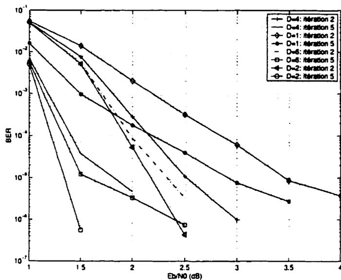
Figure III.2: Performance des codes turbo utilisant l'entrelaceur à simple décalage cyclique de taille 3600 pour différentes valeurs de  $D$  dans un canal AWGN avec  $K = 5$ ,  $G = (1, 21/37)$ ,  $R_{gp} = 1/3$
