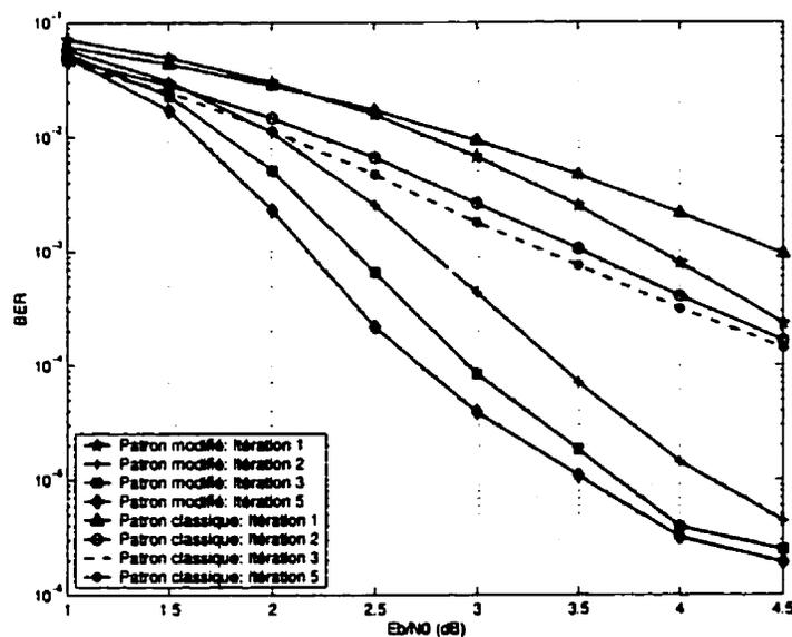
Figure IV.1: Performance des codes turbo avec les patrons de perforation classique et modifié dans un canal AWGN avec  $K = 3$ ,  $G = (1, 5/7)$ ,  $R_{gp} = 3/5$  et taille d'entrelaceur aléatoire 900
