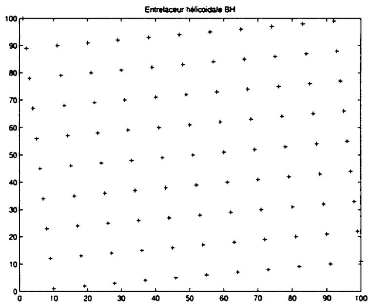
Figure I.5: Représentation matricielle de l'entrelaceur hélicoïdal BH
