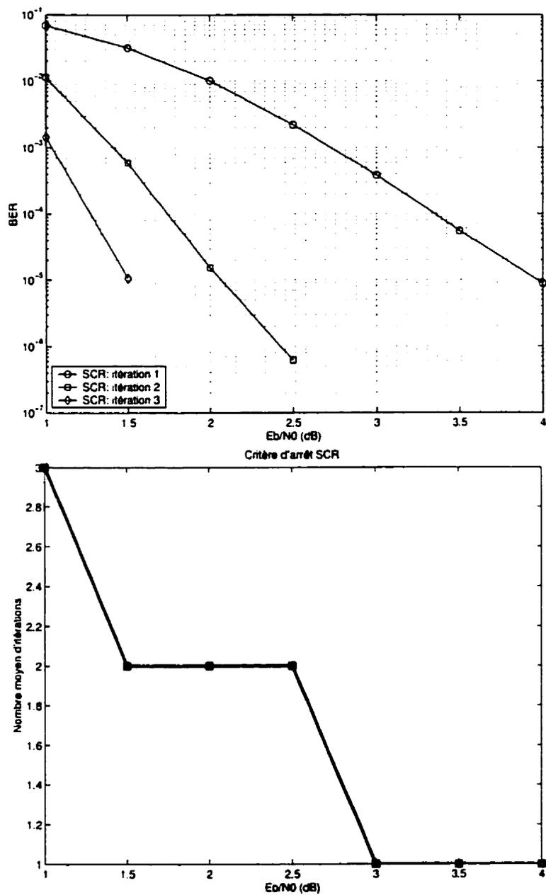
Figure 3.22: Performance du code turbo avec le critère d'arrêt SCR dans un canal AWGN avec  $\frac{C^n(i)}{N} = 0.005$ ,  $K = 5$ ,  $G = (1, 35/23)$ ,  $R_{gp} = 1/3$  et taille d'entrelaceur aléatoire 900
